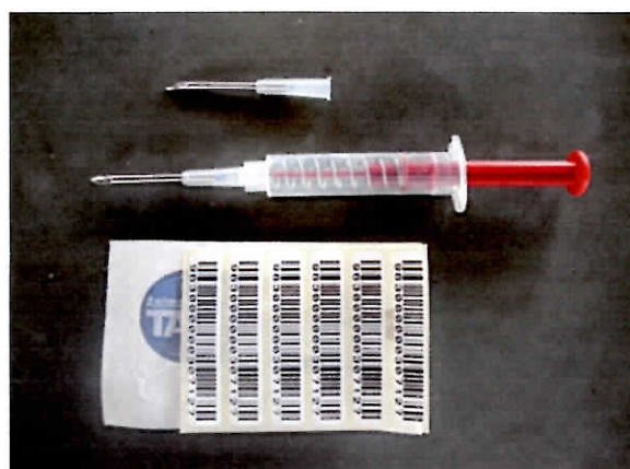
Figura 9: Kit contendo chip eletrônico, aplicador e identificado de código de barras.
