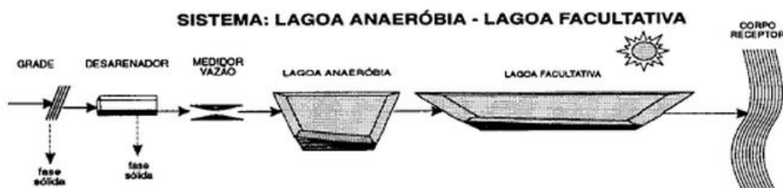
Figura 5: Fluxograma do sistema de lagoas anaeróbias seguidas por lagoas facultativas.
