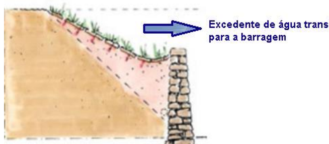
Figura 46: Exemplo de perfil esquemático de grade verde. Fonte: Relatório Técnico do Seminário Água Sustentável para o Alto Paraíso, 2013
