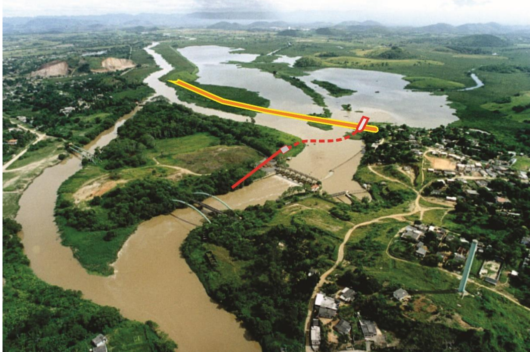
Figura 4.41 – Esquema ilustrativo de projeto de proteção da captação da ETA-Guandu.
