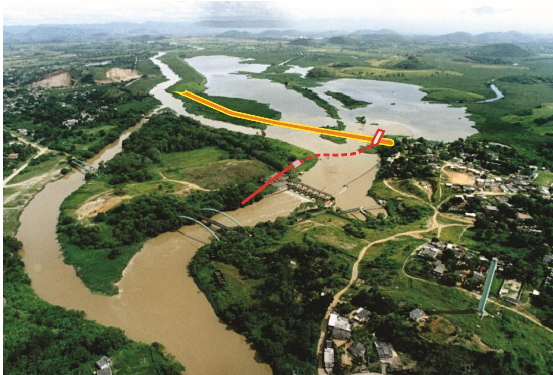
Figura 6.2: Esquema ilustrativo de projeto de proteção da captação da ETA-Guandu. Fonte: CEDAE (2014a).
