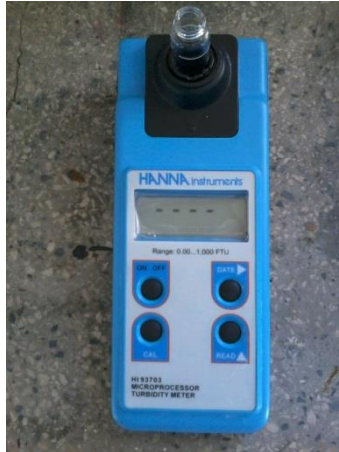
Figura 14: Equipamento utilizado nas medidas de turbidez no local de coleta.
