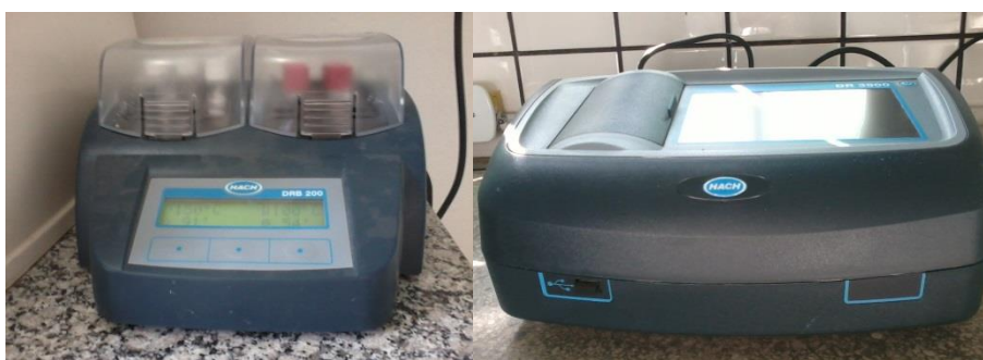
Figura 16: a) Reator digital DRB 200 (Hach) e b) Espectrofotômetro DR 3900 (Hach).
