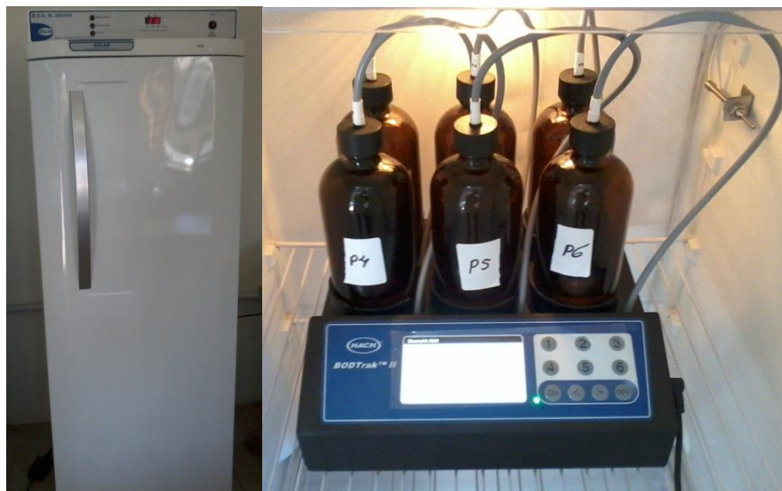
Figura 15: Incubadora de DBO e processo de incubação das amostras.
