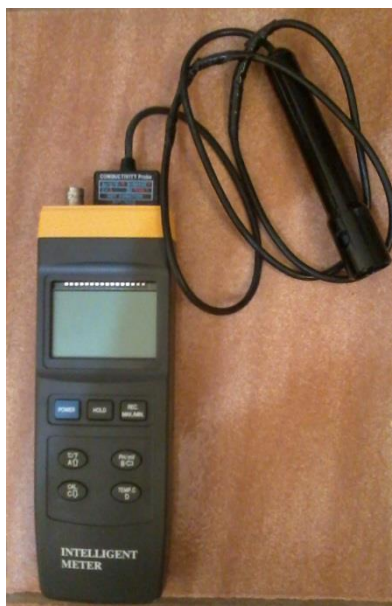
Figura 13: Equipamento utilizado nas medidas de temperatura, pH e condutividade no local de coleta.
