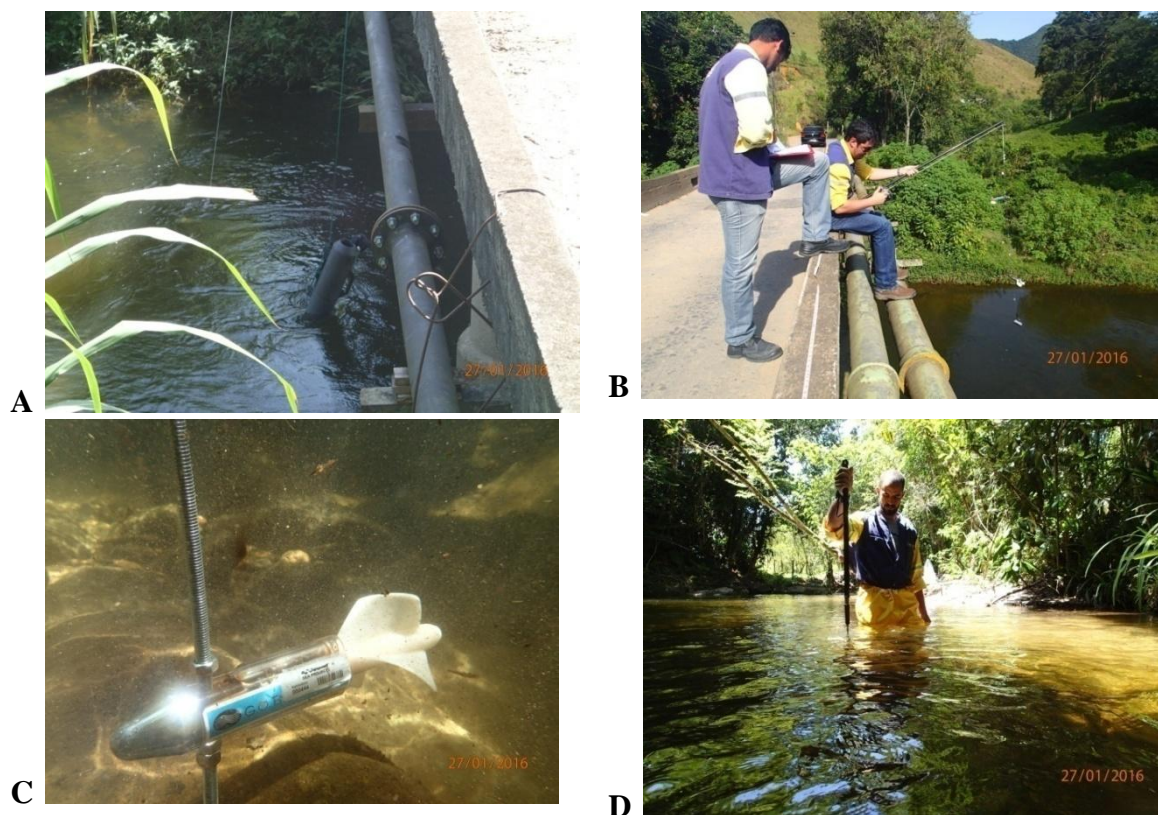
Figura 5-1: A – Coleta da amostra realiza com garrafa de niskin; B - registro em planilha de campo dos dados medidos in situ ; C – Fluxômetro utilizado para medição da vazão; D – Procedimento de medição da vazão através do molinete.
