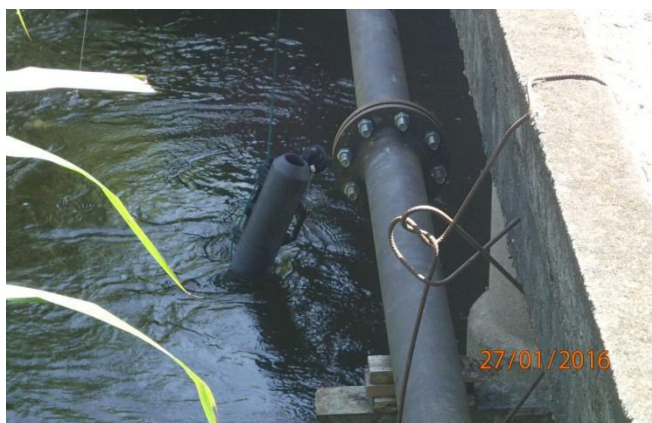
Figura 5-1: Coleta da amostra realizada com garrafa de niskin
