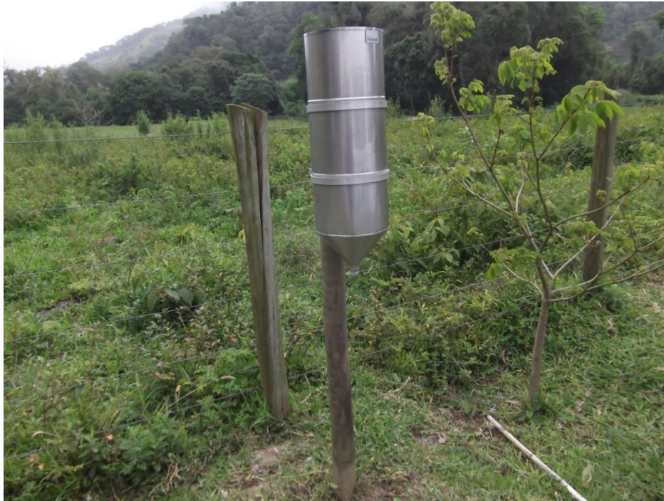
Figura 90. Pluviômetro Manual no ITPA
