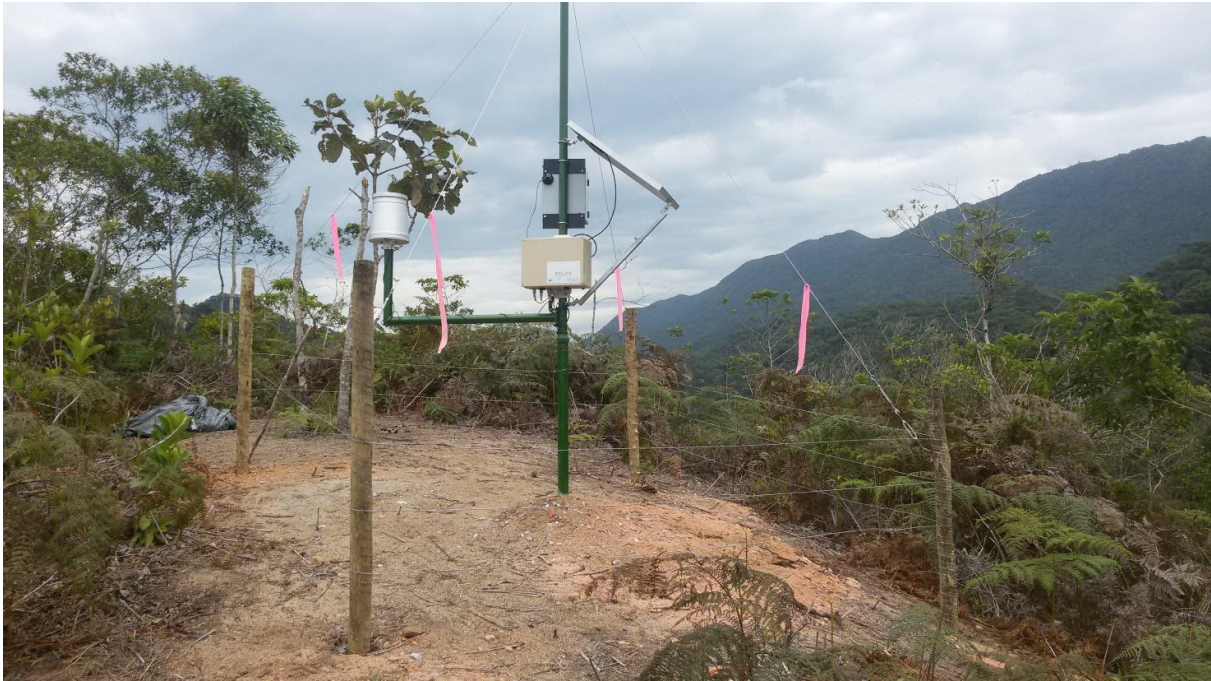
Figura 92. Pluviômetro Automático na RPPN Fazenda Sambaíba
