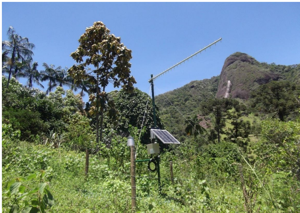
Figura 84. Pluviômetro Automático no Sítio Alto da Serra
