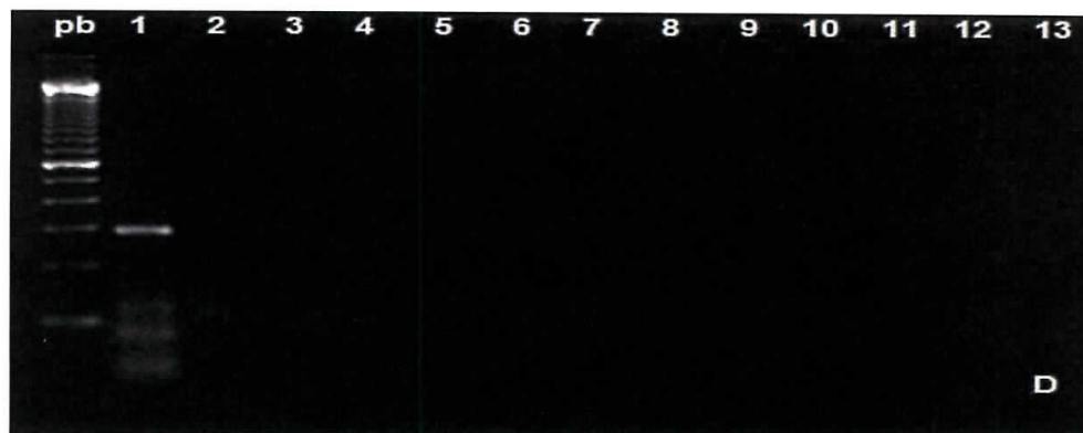
Figura 9: Eletroforese em gel de agarose a 2% dos produtos de PCR das amostras da bacia hidrográfica do rio Guandu para detecção de Bacteroidales de humano (291pb). Poços: (bp) 100bp DNA Ladder; (1) fezes de humano; (2) rio Pirai; (3) rio Queimados; (4) rio Macacos; (5) rio Santana; (6) barragem de Santa Cecília; (7) calha de Ribeirão das Lajes; (8) barragem Principal; (9) rio Guandu; (10) rio Poços; (11) final da Lagoa; (12) Neisseria gonorrhoeae INCQS 00601 (ATCC 49226); (13) H2O Gibco®.
