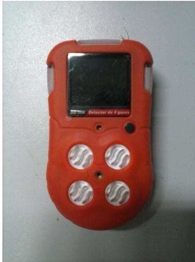
**Figura 10.** Detector digital para a quantificação da concentração dos gases do biogás gerado.
