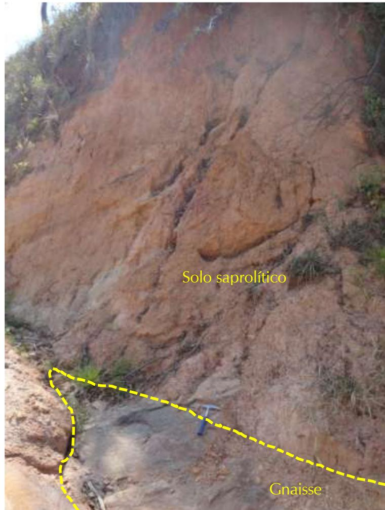
Foto 2.4 - Perfil de solo sobre o afloramento gnáissico em talude na margem esquerda
