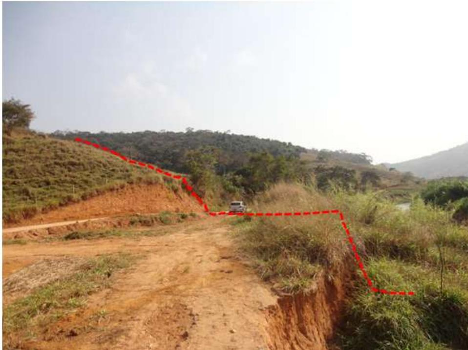
*Foto 2.14 - margem direita mostrando o talude em solo saprolítico e/ou colúvio-residual e deslizamentos na margem do rio, onde também se encontrou trincas de tração.*
