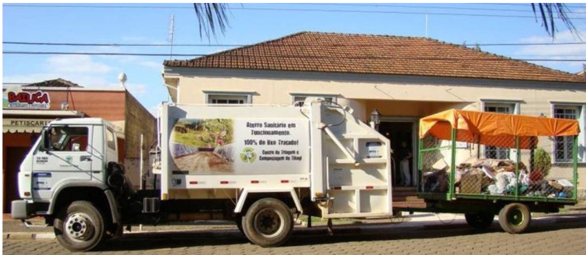
Figura 94 - Carroceria adaptada para coleta seletiva Fonte: Prefeitura Municipal de Tibagi
