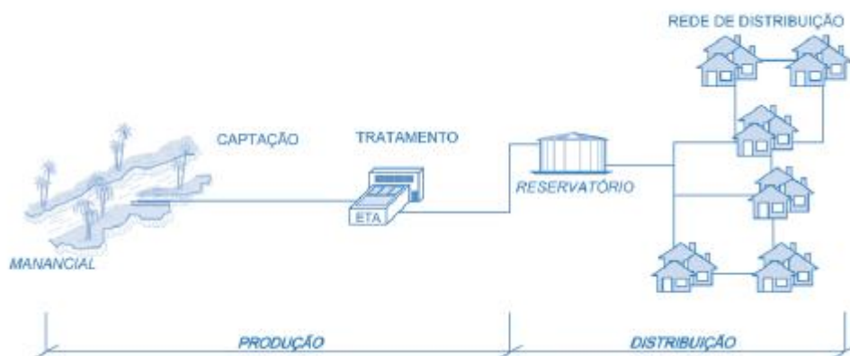
Figura 7. Esquema simplificado de um sistema de abastecimento de água. Fonte: CEDAE (2018).
