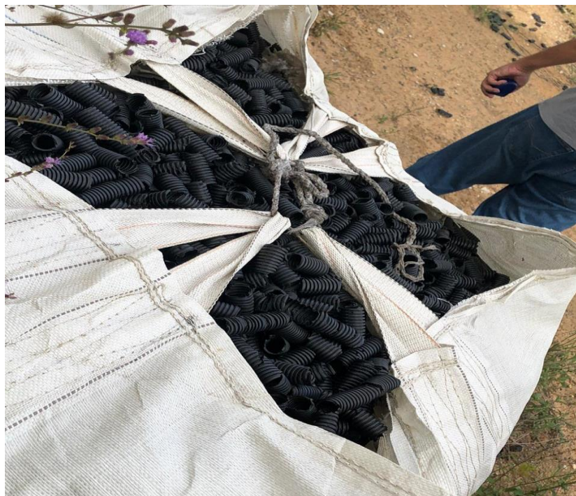
Figura 19. Meio suporte do Filtro Aerado Submerso da ETE de Miracema/RJ. Fonte: Arquivo pessoal, 2020
