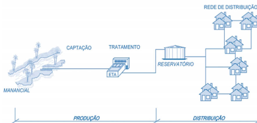
Figura 2. Esquema simplificado de um sistema de abastecimento. Fonte: Relatório Anual de Informações aos Usuários - Miracema (CEDAE, 2018).
