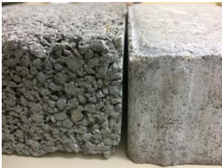
Figura 12. Diferenças entre pavimento em concreto permeável (à esquerda) e concreto impermeável (à direita). Fonte: UFES, 2019
