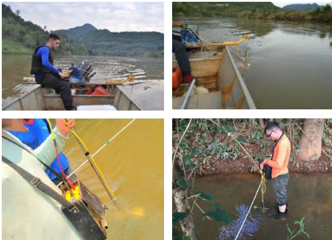
Figura 6.2 Medição de descarga líquida com molinete hidrométrico embarcado e a vau (ÁGUA E SOLO, 2019).
