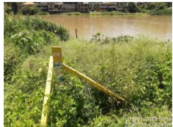
Figura 4.147. RJ06 - Réguas limnimétricas.
