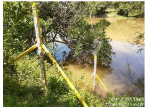
Figura 4.199. RJ13 - Régua limnimétrica.
