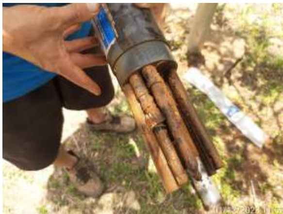
Figura 4.210. RJ15 - Sonda antes da limpeza.
