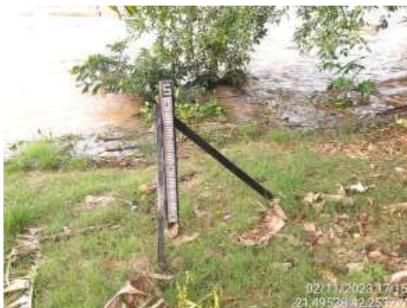
Figura 4.264. RJ29 - Régua limnimétrica.
