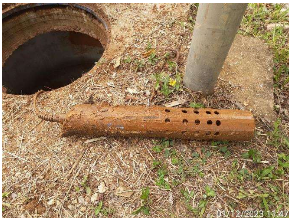
Figura 2.11. RJ15 - Sonda antes da limpeza.
