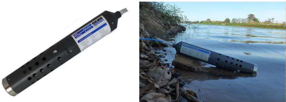
Figura 3. Sonda multiparamétrica modelo MPS K16.
