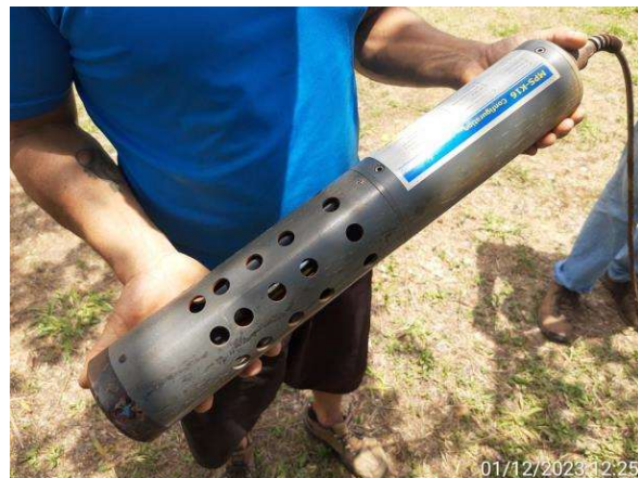
Figura 2.12. RJ15 - Sonda após a limpeza.
