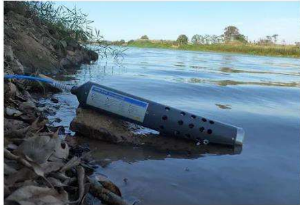
Figura 2.1. Sonda multiparamétrica modelo MPS K16.
