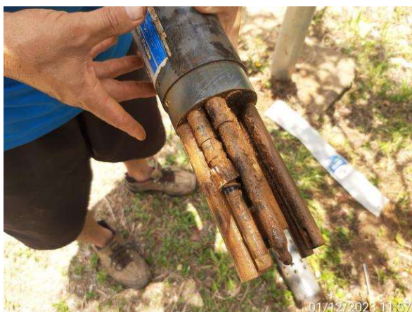
Figura 2.13. RJ15 - Sensores antes da limpeza.
