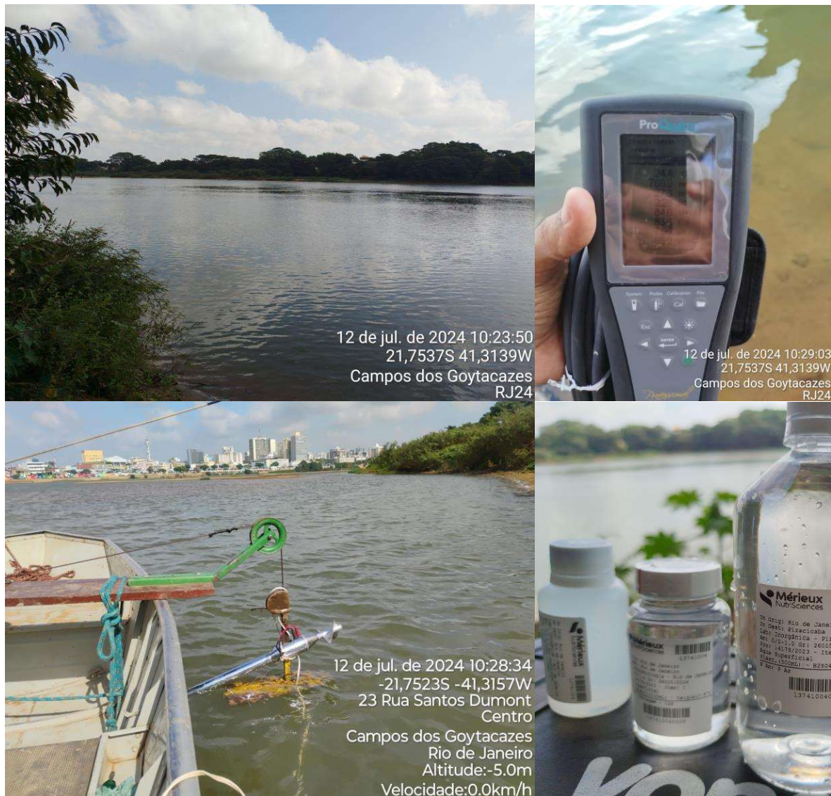
Figura 4.48. Registros fotográficos do ponto RJ24 - Ponte Saturnino de Brito, destacando a seção de medição, a medição de vazão e de parâmetros de qualidade da água, e a coleta de amostras de água.
