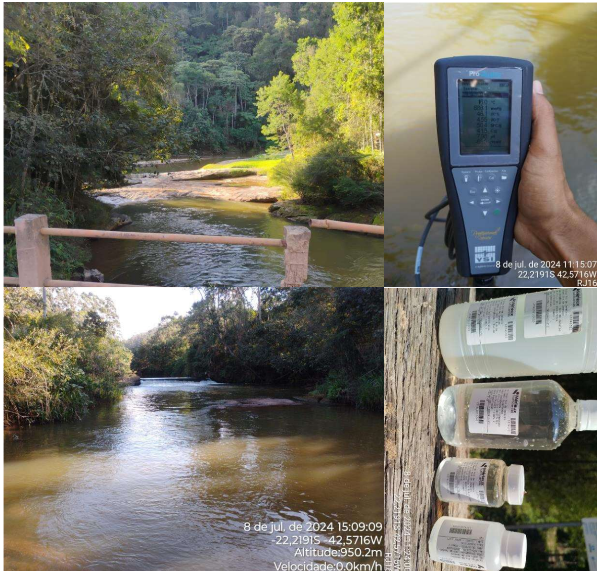
Figura 4.30. Registros fotográficos do ponto RJ15 - Ponte estrada Dona Mariana, destacando a seção de medição, a medição de vazão e de parâmetros de qualidade da água, e a coleta de amostras de água.
