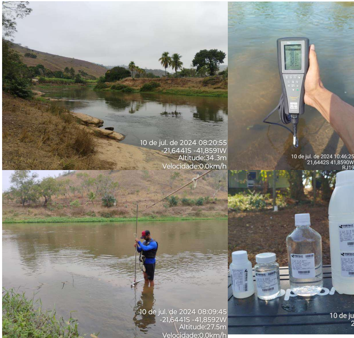
Figura 4.38. Registros fotográficos do ponto RJ19 - Dois irmãos, destacando a seção de medição, a medição de vazão e de parâmetros de qualidade da água, e a coleta de amostras de água.
