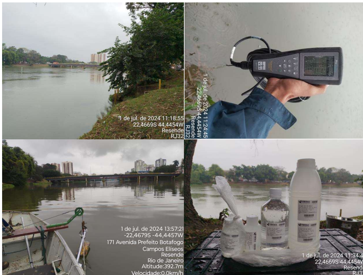
Figura 4.64. Registros fotográficos do ponto RJ32 - Resende, destacando a seção de medição, a medição de vazão e de parâmetros de qualidade da água, e a coleta de amostras de água.
