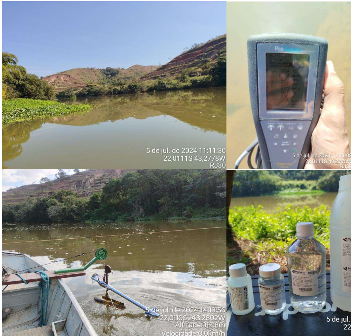
Figura 4.60. Registros fotográficos do ponto RJ30 - Triunfo, destacando a seção de medição, a medição de vazão e de parâmetros de qualidade da água, e a coleta de amostras de água.
