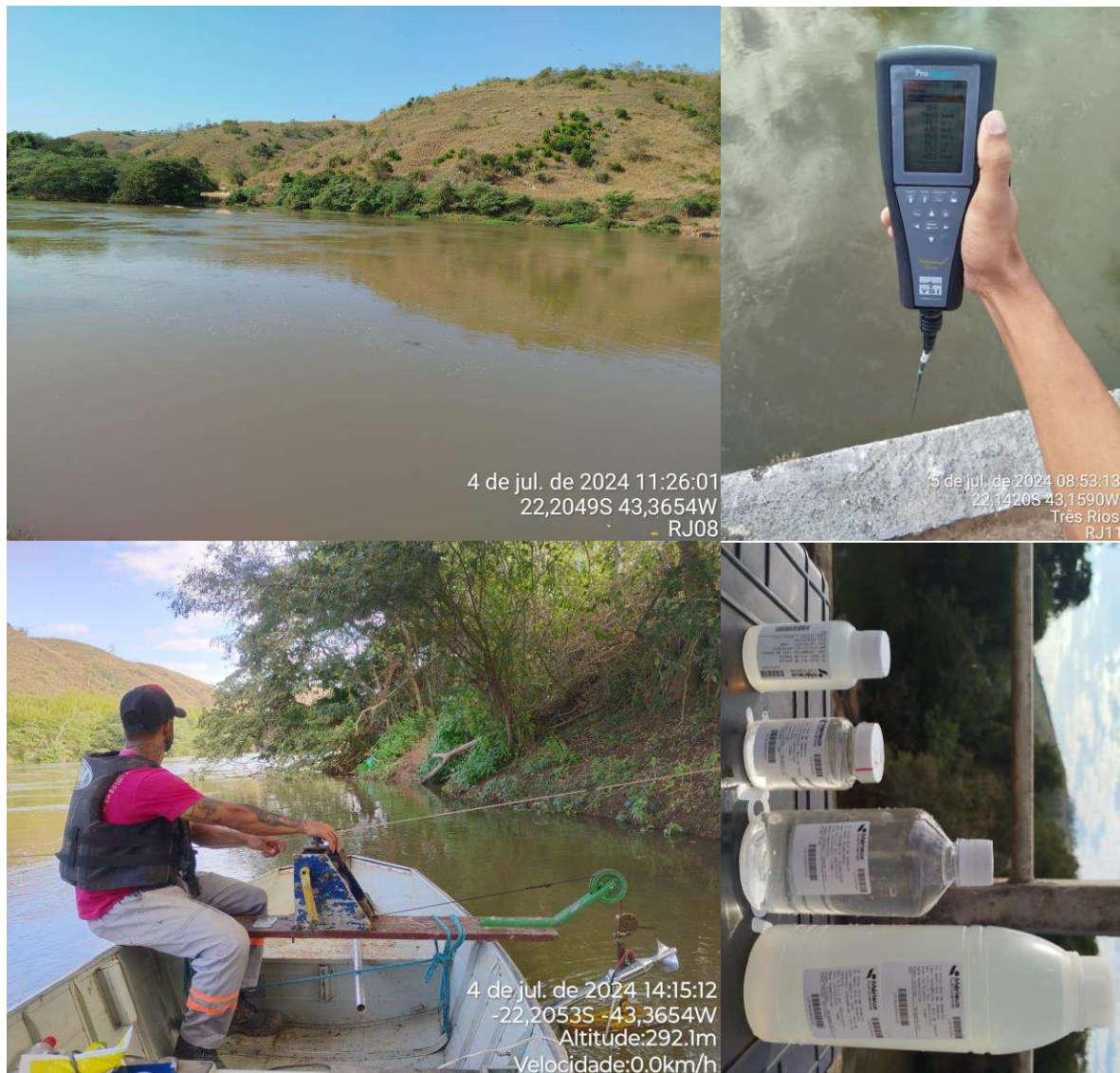
Figura 4.16. Registros fotográficos do ponto RJ08 - Cerâmica GGP, destacando a seção de medição, a medição de vazão e de parâmetros de qualidade da água, e a coleta de amostras de água.
