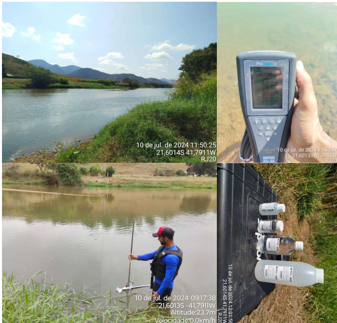
Figura 4.40. Registros fotográficos do ponto RJ20 - Encontro dos Rios, destacando a seção de medição, a medição de vazão e de parâmetros de qualidade da água, e a coleta de amostras de água.
