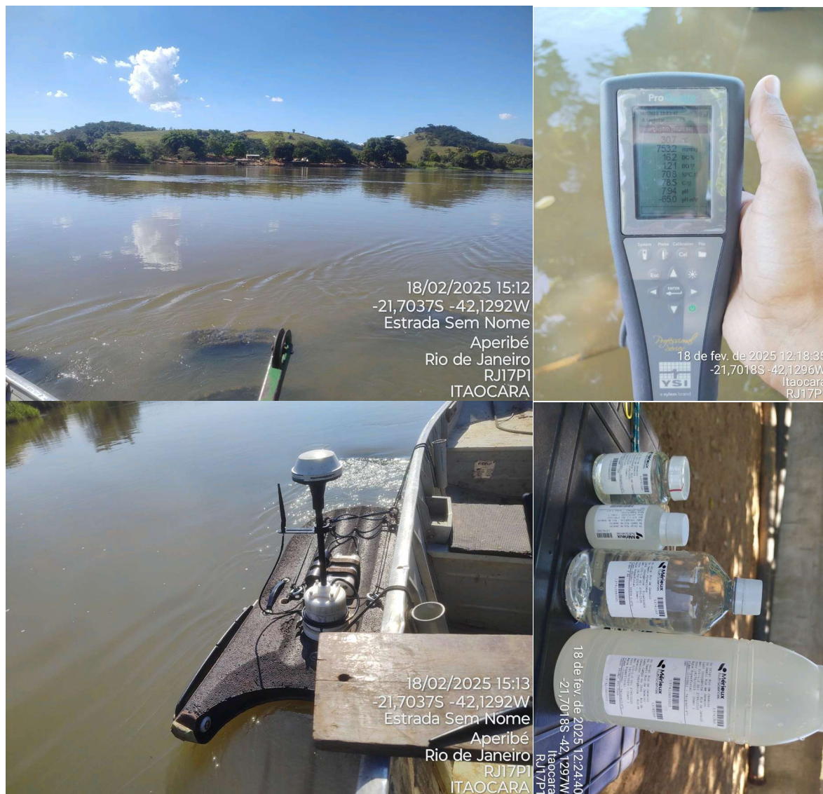
Figura 4.34. Registros fotográficos do ponto RJ17 - Itaocara, destacando a seção de medição, a medição de vazão e de parâmetros de qualidade da água, e a coleta de amostras de água.
