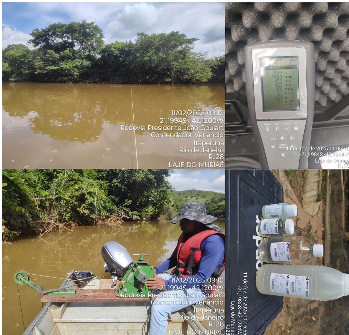
Figura 4.56. Registros fotográficos do ponto RJ28 - Laje de Muriaé, destacando a seção de medição, a medição de vazão e de parâmetros de qualidade da água, e a coleta de amostras de água.
