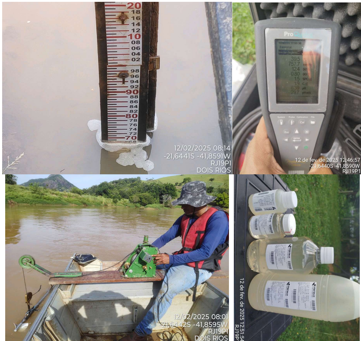
Figura 4.38. Registros fotográficos do ponto RJ19 - Dois rios, destacando a seção de medição, a medição de vazão e de parâmetros de qualidade da água, e a coleta de amostras de água.
