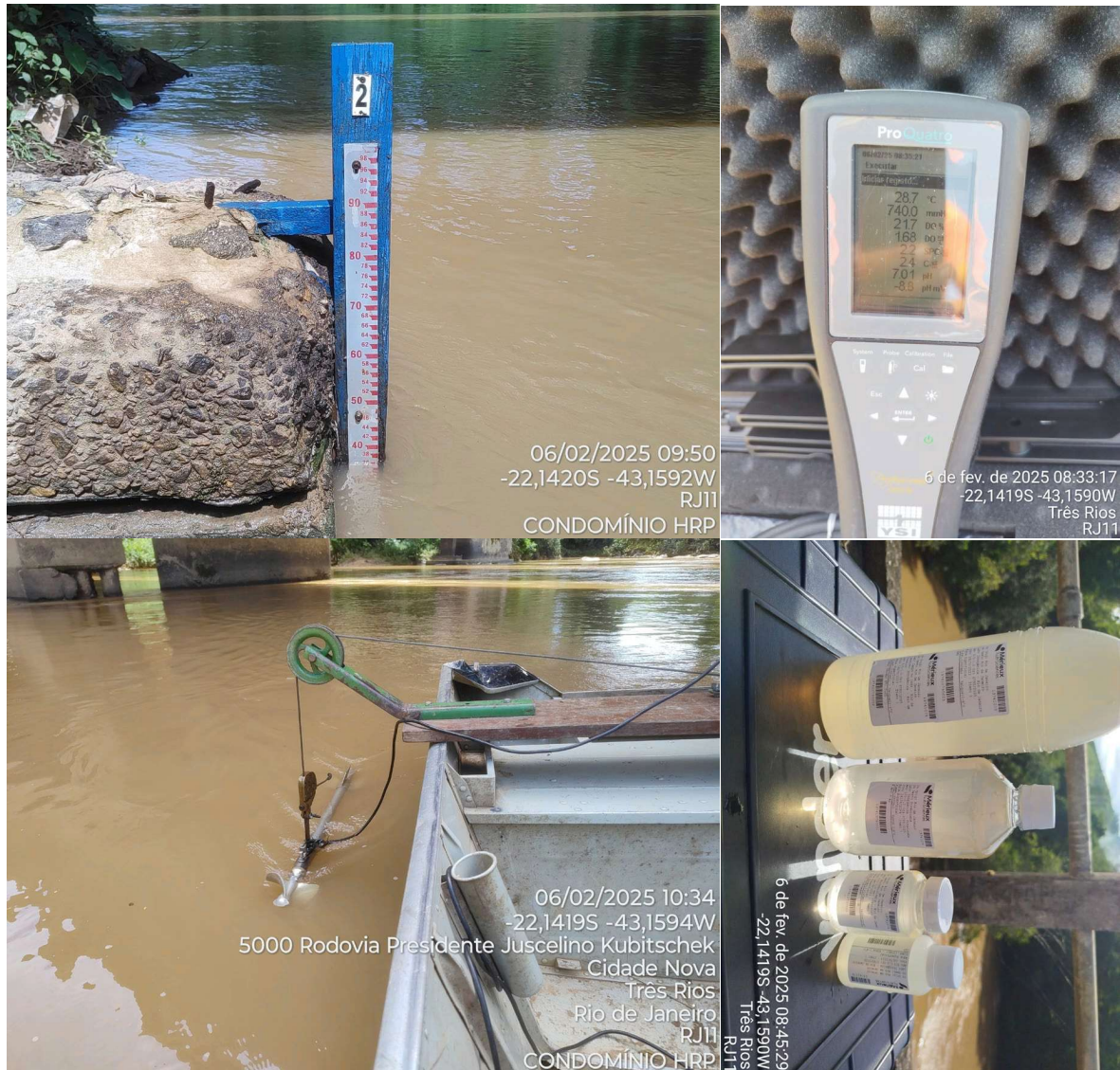
Figura 4.22. Registros fotográficos do ponto RJ11 - Estação Condomínio HRP, destacando a seção de medição, a medição de vazão e de parâmetros de qualidade da água, e a coleta de amostras de água.
