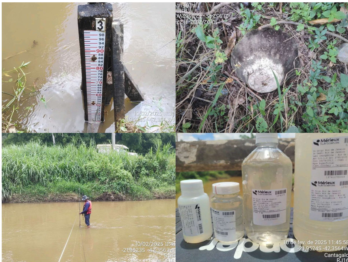
Figura 4.32. Registros fotográficos do ponto RJ16 - Aldeia, destacando a seção de medição, a medição de vazão e de parâmetros de qualidade da água, e a coleta de amostras de água.
