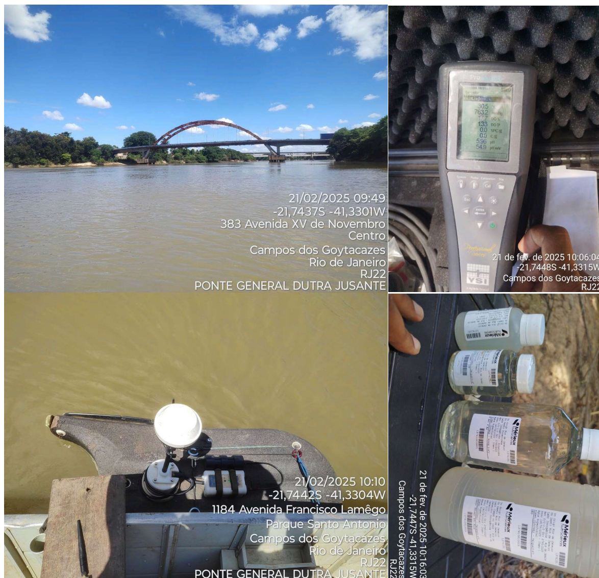
Figura 4.44. Registros fotográficos do ponto RJ22 - Ponte General Dutra Jusante, destacando a seção de medição, a medição de vazão e de parâmetros de qualidade da água, e a coleta de amostras de água.
