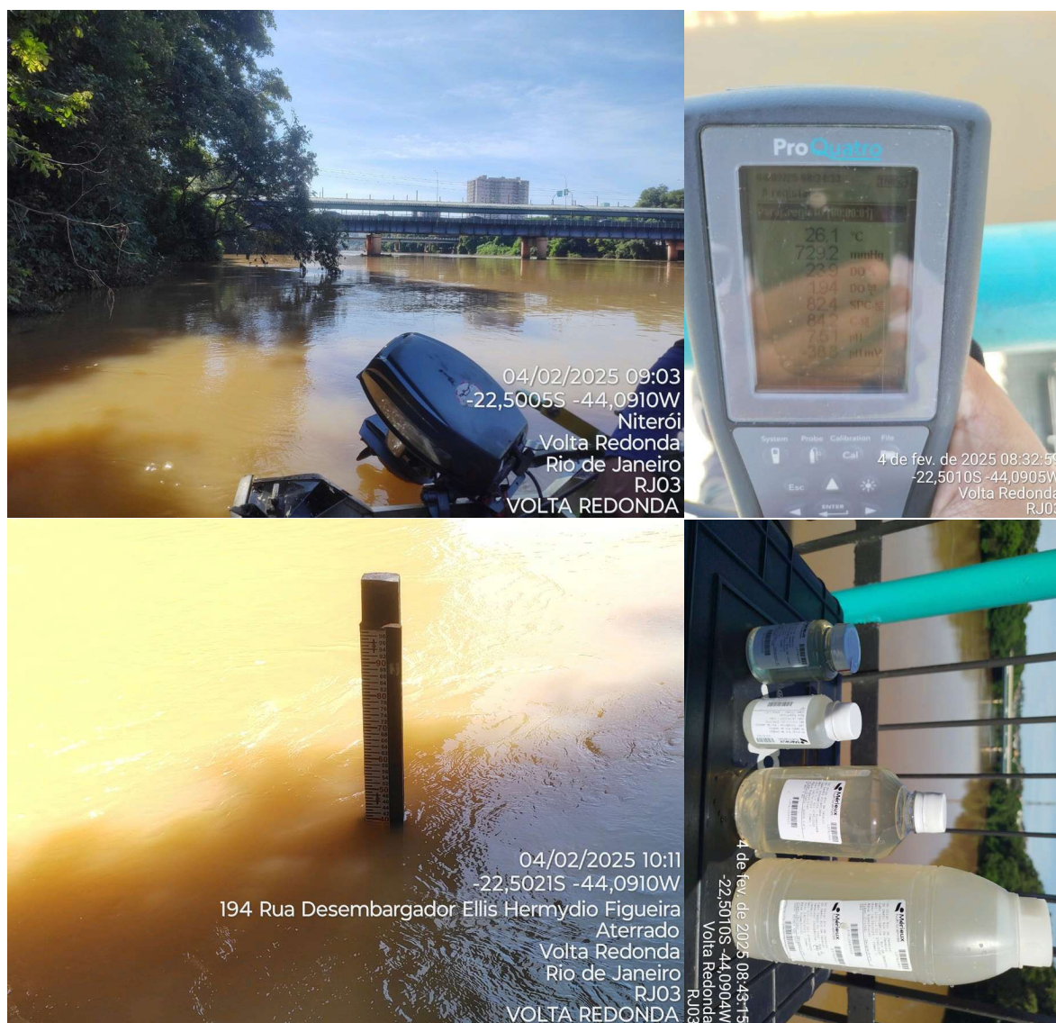
Figura 4.6. Registros fotográficos do ponto RJ03 - Volta Redonda, destacando a seção de medição, a medição de vazão e de parâmetros de qualidade da água, e a coleta de amostras de água.
