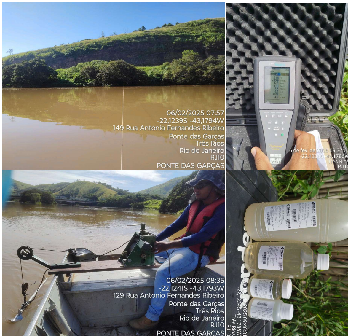
Figura 4.20. Registros fotográficos do ponto RJ10 - Ponto das Garças, destacando a seção de medição, a medição de vazão e de parâmetros de qualidade da água, e a coleta de amostras de água.
