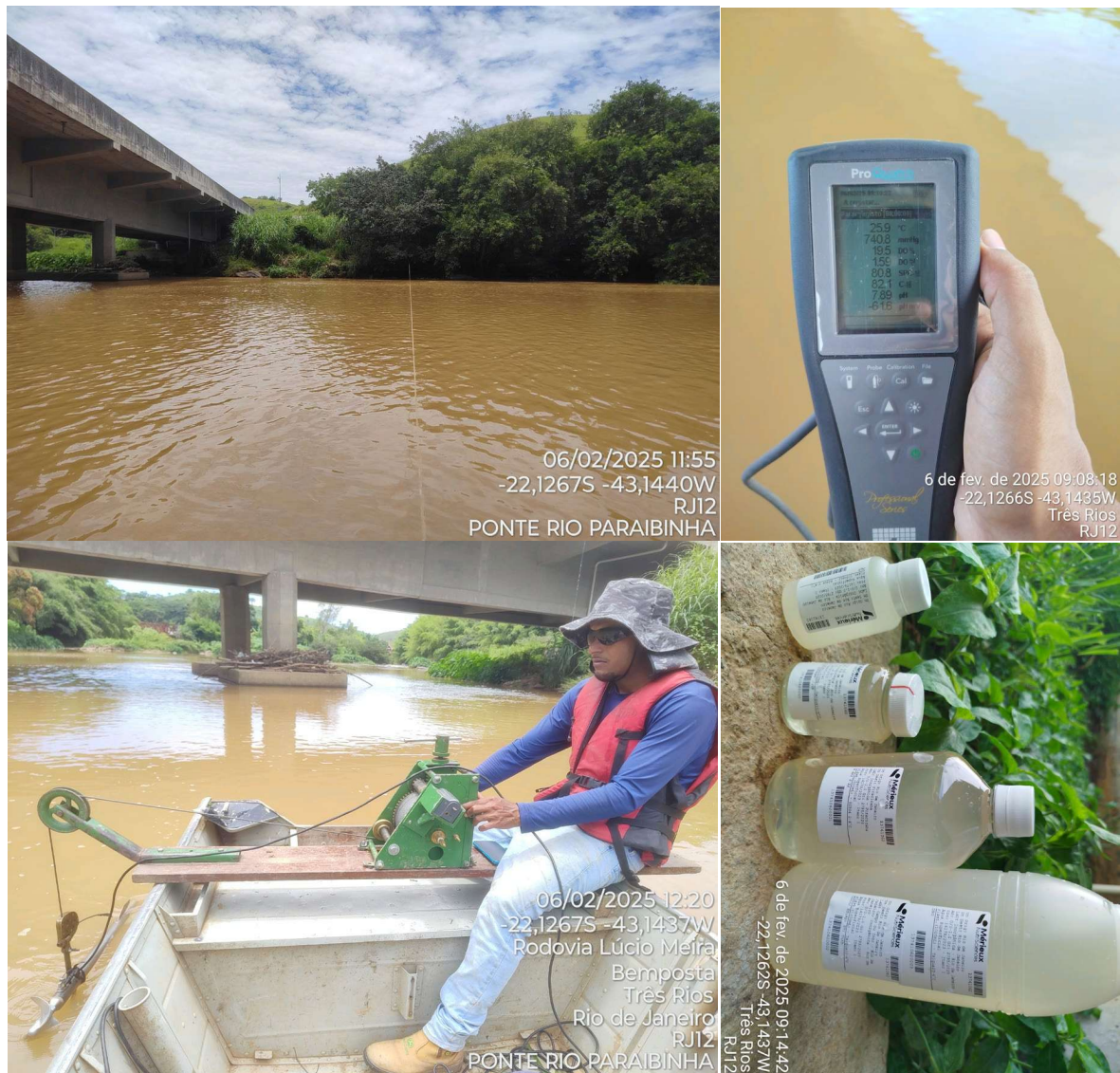
Figura 4.24. Registros fotográficos do ponto RJ12 - Ponte Rio Paraibinha, destacando a seção de medição, a medição de vazão e de parâmetros de qualidade da água, e a coleta de amostras de água.
