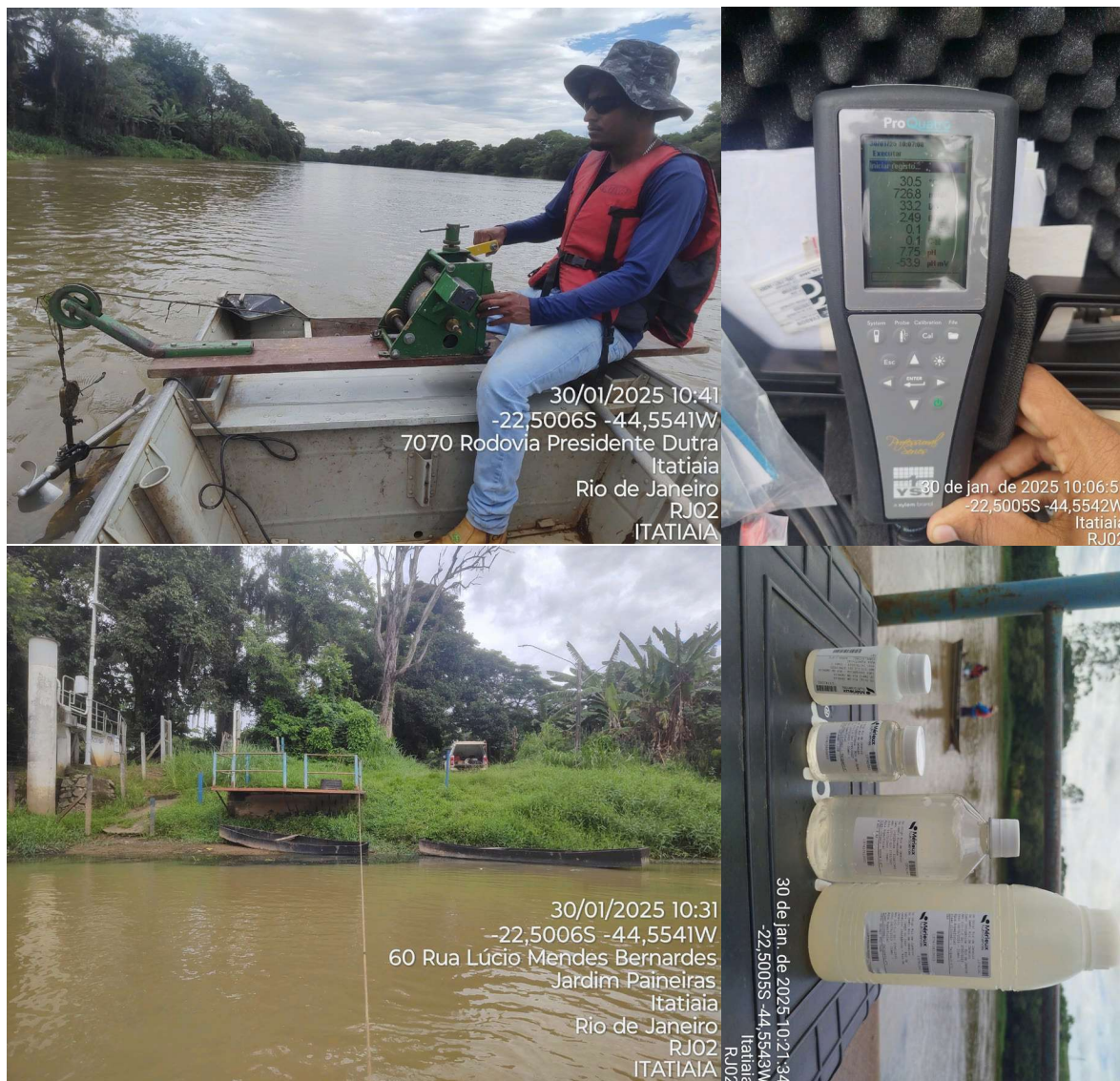
Figura 4.4. Registros fotográficos do ponto RJ02 - Itatiaia, destacando a seção de medição, a medição de vazão e de parâmetros de qualidade da água, e a coleta de amostras de água.
