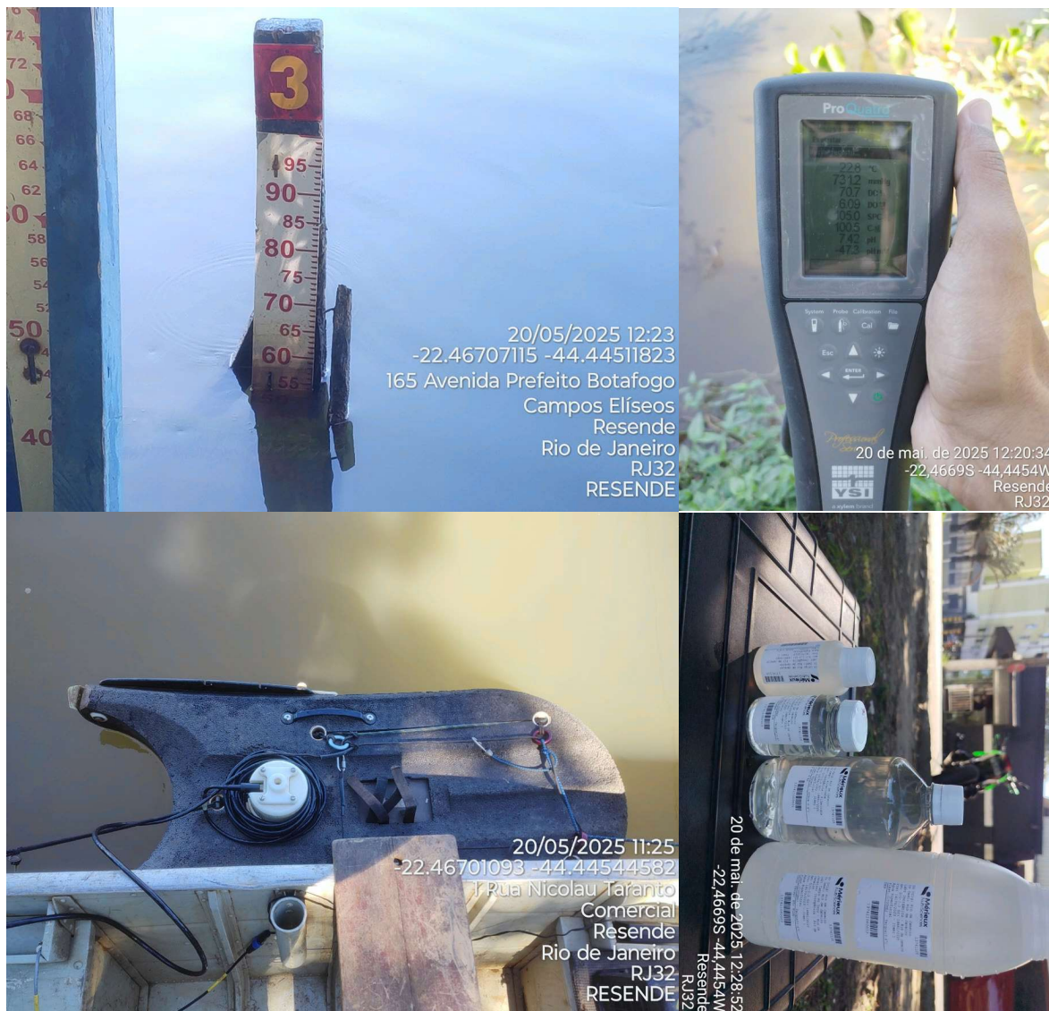
Figura 4.64. Registros fotográficos do ponto RJ32 - Resende, destacando a seção de medição, a medição de vazão e de parâmetros de qualidade da água, e a coleta de amostras de água.
