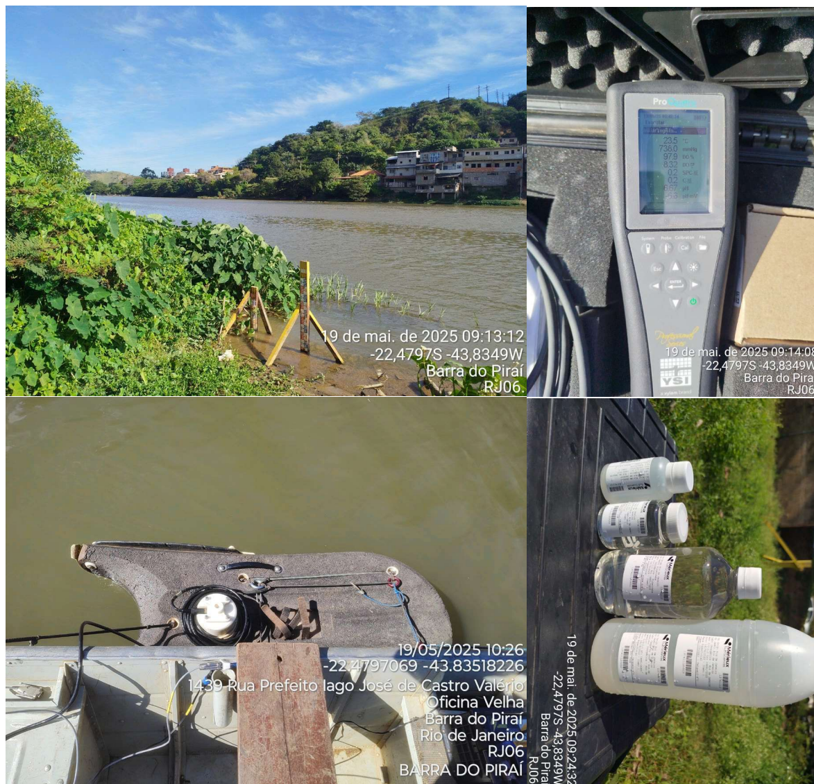
Figura 4.12. Registros fotográficos do ponto RJ06 - Barra do Pirai, destacando a seção de medição, a medição de vazão e de parâmetros de qualidade da água, e a coleta de amostras de água.
