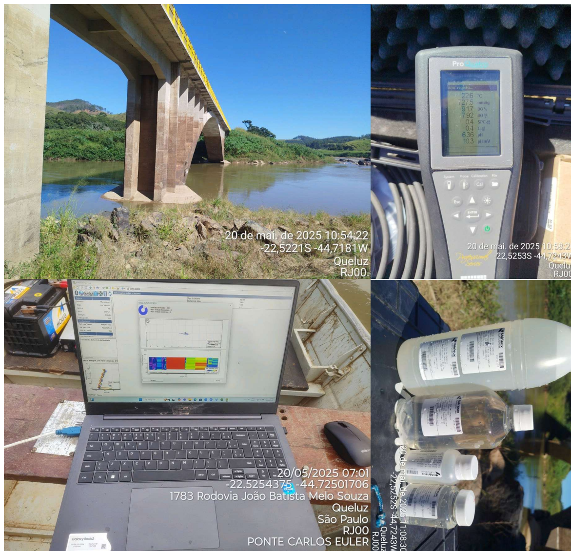
Figura 4.1. Registros fotográficos do ponto RJ00 - Ponte Carlos Euler, destacando a seção de medição, a medição de vazão e de parâmetros de qualidade da água, e a coleta de amostras de água.
