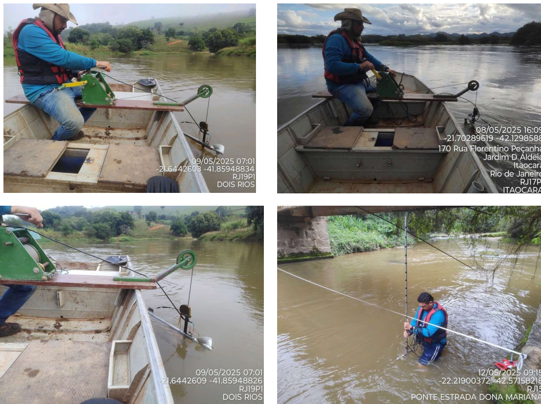
Figura 3.1 Medição de descarga líquida com molinete hidrométrico embarcado e a vau (ÁGUA E SOLO, 2025).
