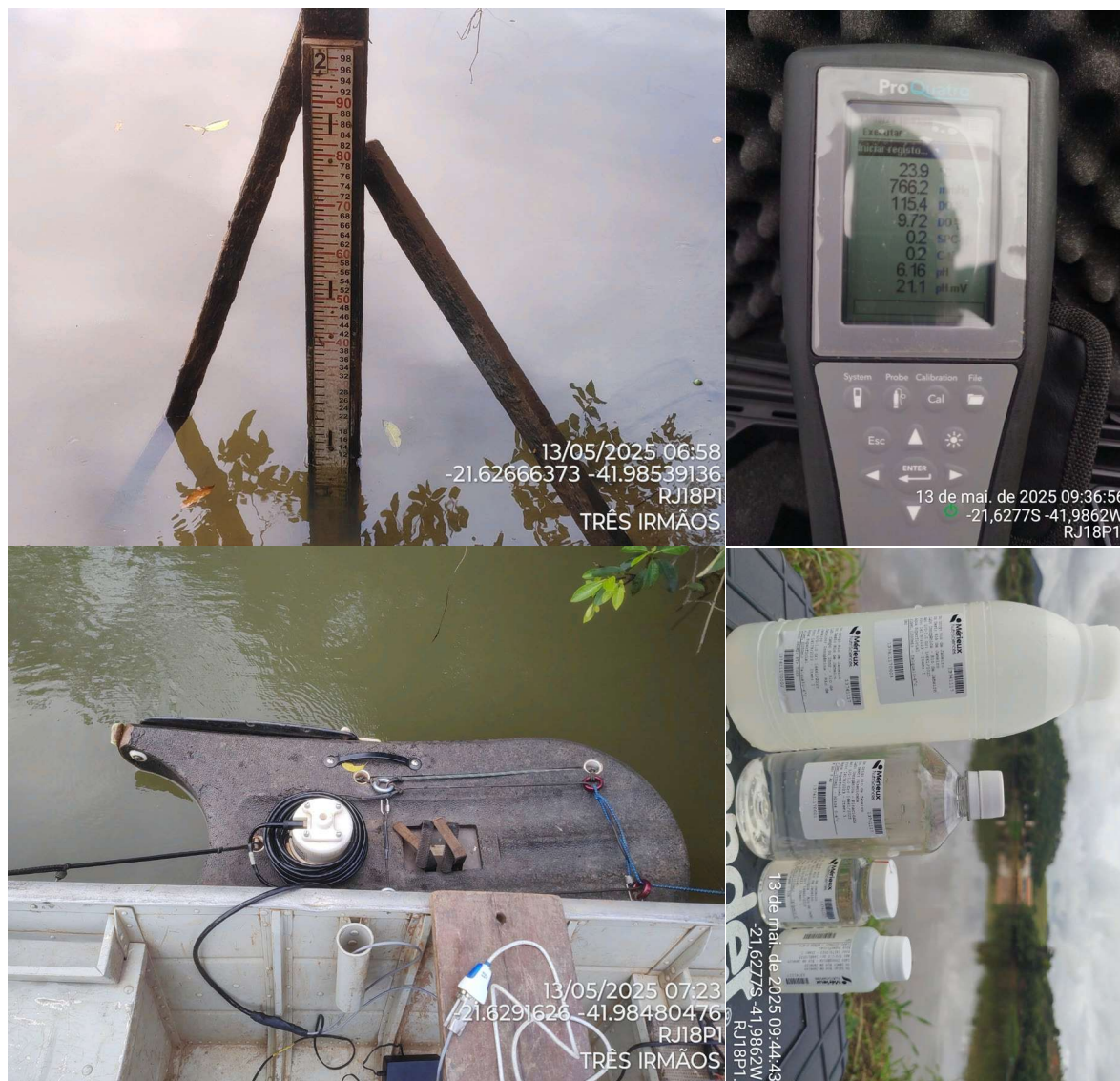
Figura 4.36. Registros fotográficos do ponto RJ18 - Três irmãos, destacando a seção de medição, a medição de vazão e de parâmetros de qualidade da água, e a coleta de amostras de água.
