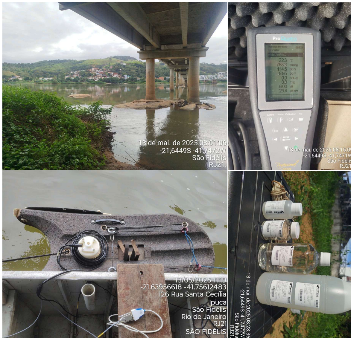
Figura 4.42. Registros fotográficos do ponto RJ21 - São Fidelis, destacando a seção de medição, a medição de vazão e de parâmetros de qualidade da água, e a coleta de amostras de água.
