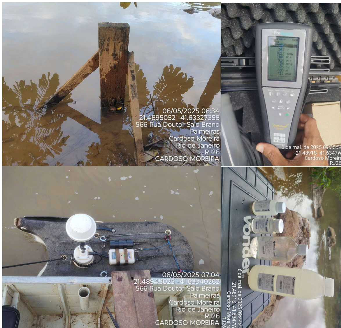
Figura 4.52. Registros fotográficos do ponto RJ26 - Cardoso Moreira, destacando a seção de medição, a medição de vazão e de parâmetros de qualidade da água, e a coleta de amostras de água.
