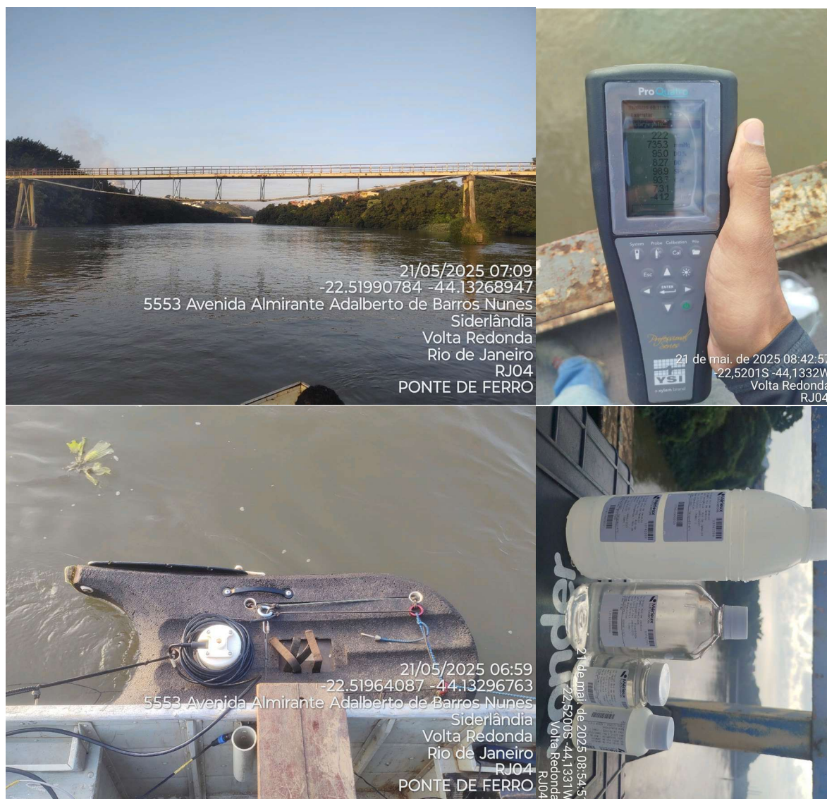
Figura 4.8. Registros fotográficos do ponto RJ04 - Ponte de Ferro, destacando a seção de medição, a medição de vazão e de parâmetros de qualidade da água, e a coleta de amostras de água.
