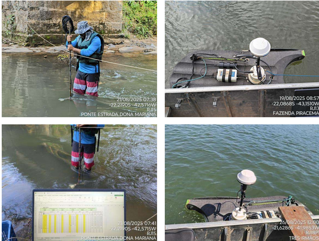
Figura 3.1 Medição de descarga líquida com molinete hidrométrico a vau, ADCP a barco com cabo de aço e com motor (ÁGUA E SOLO, 2025).
