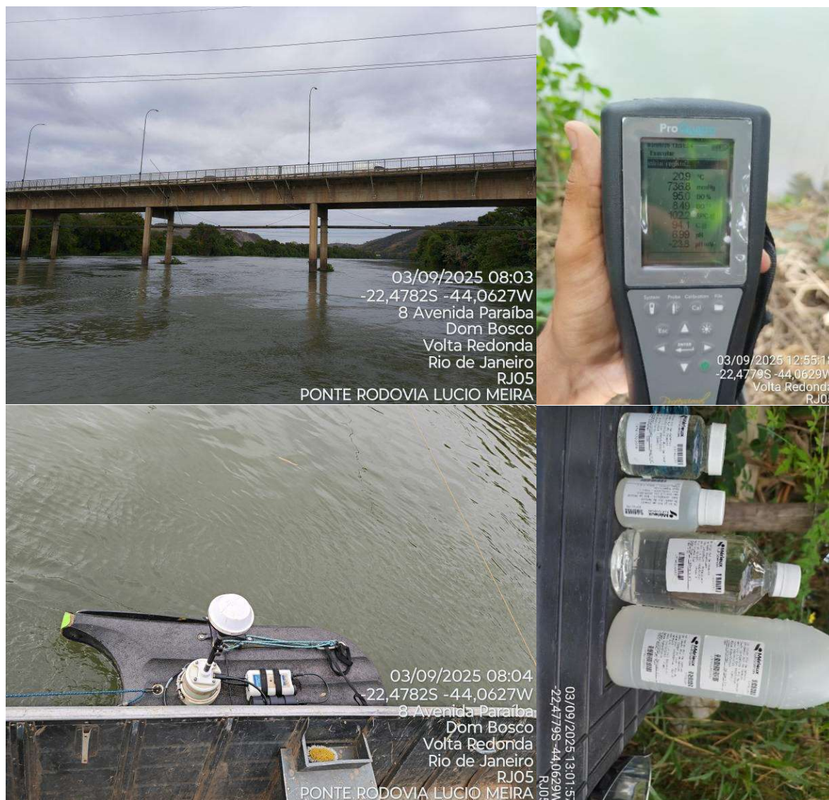
Figura 4.10. Registros fotográficos do ponto RJ05 - Ponte Rodovia Lucio Meira, destacando a seção de medição, a medição de vazão e de parâmetros de qualidade da água, e a coleta de amostras de água.
