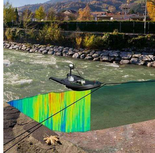
Figura 3.3 Sensor e representação da aplicação do equipamento ADCP em um rio (SON TEK – XYLEM)
