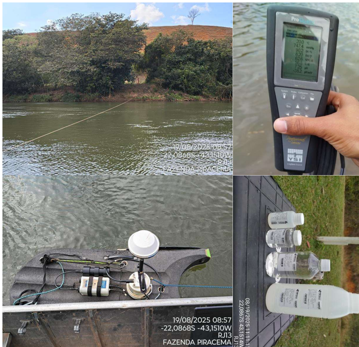
Figura 4.26. Registros fotográficos do ponto RJ13 - Fazenda Piracema, destacando a seção de medição, a medição de vazão e de parâmetros de qualidade da água, e a coleta de amostras de água.
