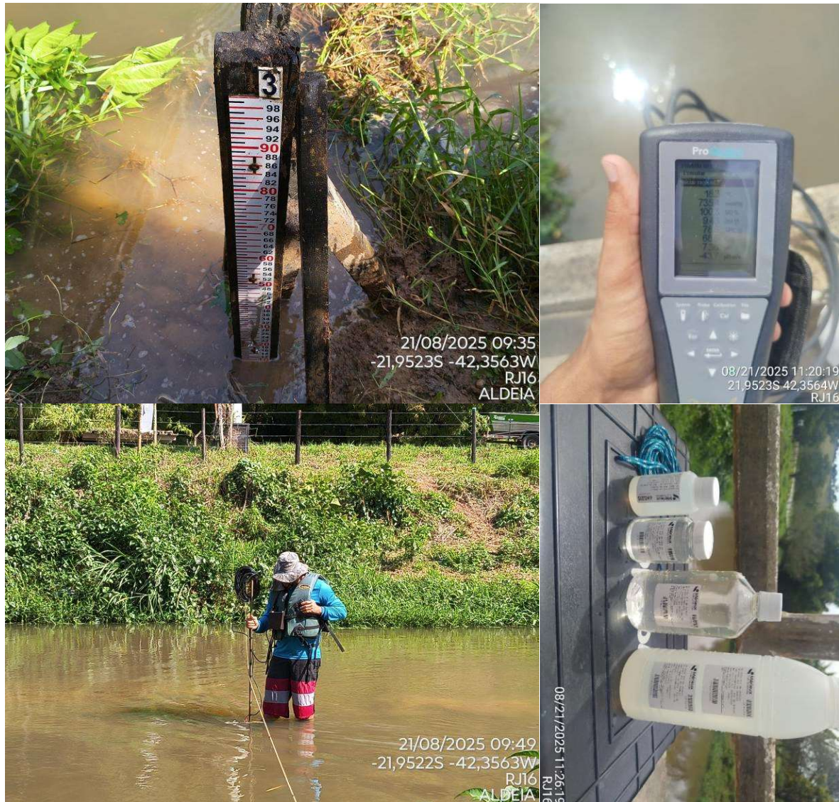
Figura 4.32. Registros fotográficos do ponto RJ16 - Aldeia, destacando a seção de medição, a medição de vazão e de parâmetros de qualidade da água, e a coleta de amostras de água.
