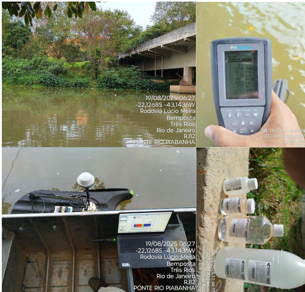
Figura 4.24. Registros fotográficos do ponto RJ12 - Ponte Rio Paraíbinha, destacando a seção de medição, a medição de vazão e de parâmetros de qualidade da água, e a coleta de amostras de água.
