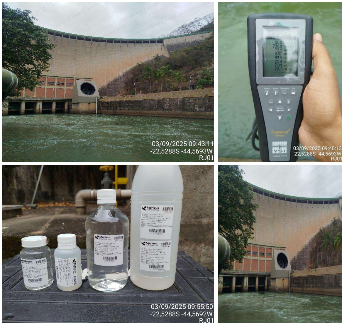
Figura 4.3. Registros fotográficos do ponto RJ01 - Usina do Funil, destacando a medição de parâmetros de qualidade da água, e a coleta de amostras de água
