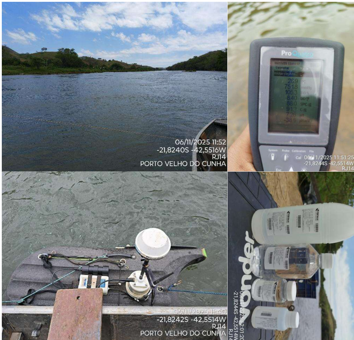
Figura 4.28. Registros fotográficos do ponto RJ14 - Porto velho do Cunha, destacando a seção de medição, a medição de vazão e de parâmetros de qualidade da água, e a coleta de amostras de água.
