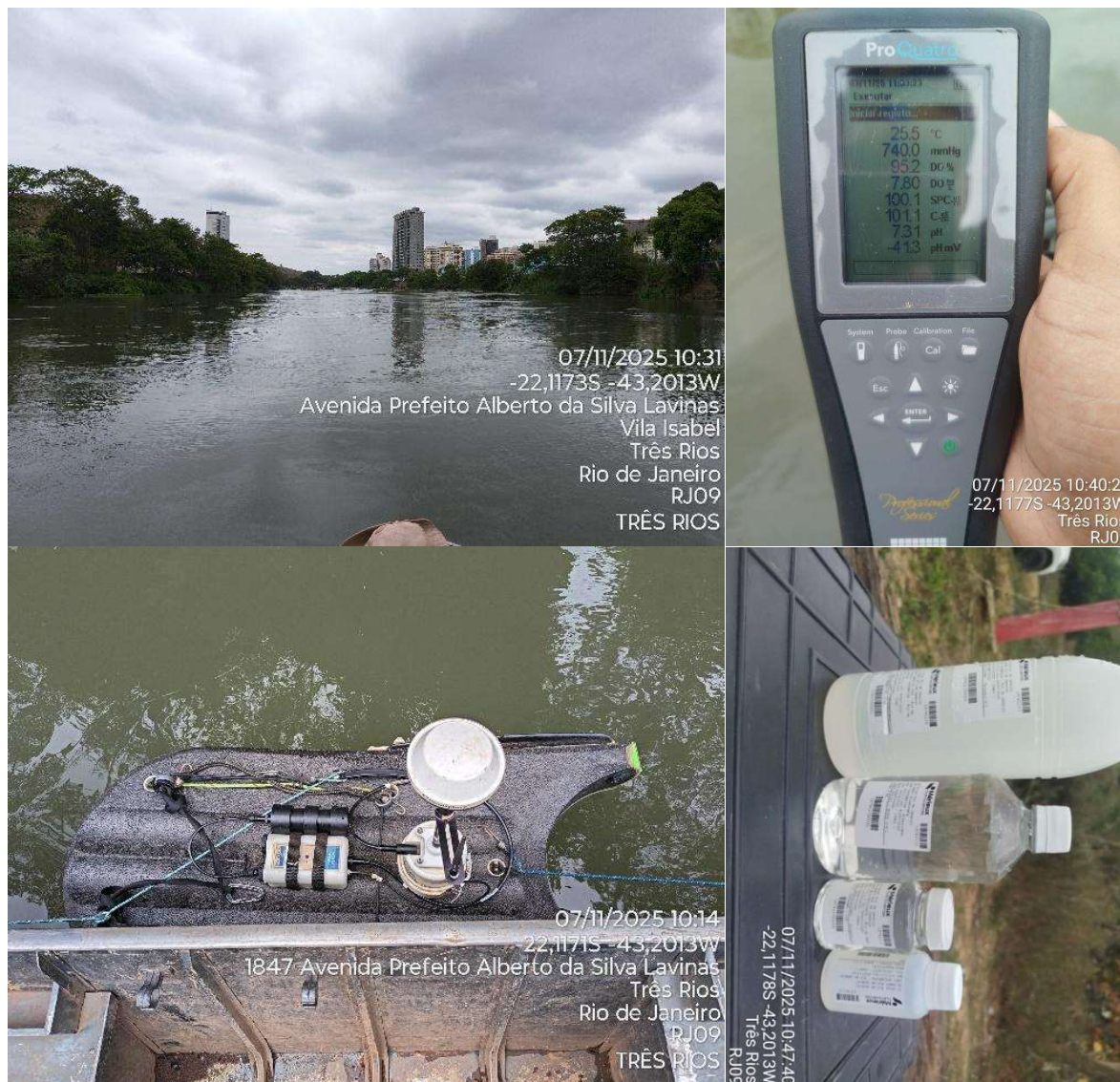
Figura 4.18. Registros fotográficos do ponto RJ09 - Três Rios, destacando a seção de medição, a medição de vazão e de parâmetros de qualidade da água, e a coleta de amostras de água.
