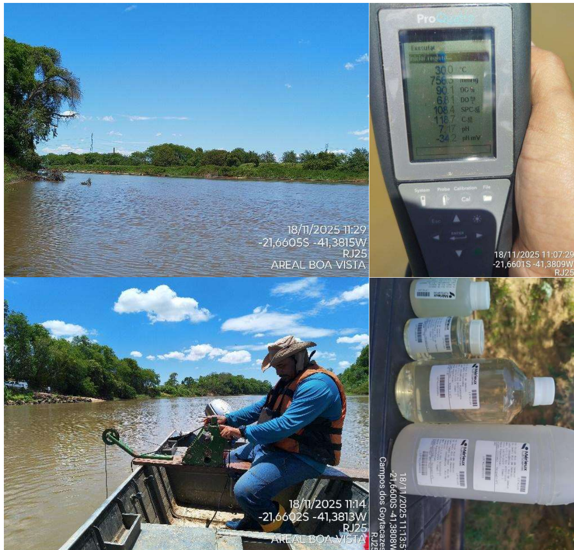
Figura 4.50. Registros fotográficos do ponto RJ25 - Areal Boa Vista, destacando a seção de medição, a medição de vazão e de parâmetros de qualidade da água, e a coleta de amostras de água.
