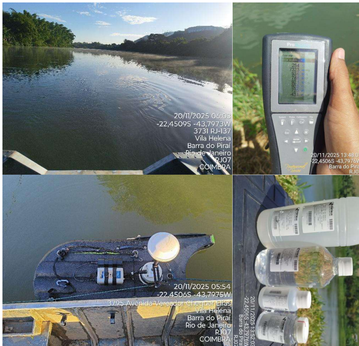
Figura 4.14. Registros fotográficos do ponto RJ07 - Coimbra, destacando a seção de medição, a medição de vazão e de parâmetros de qualidade da água, e a coleta de amostras de água.
