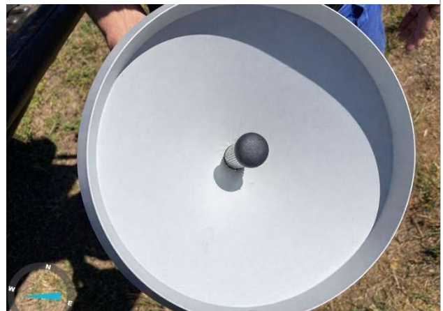
Figura 2.6 - Pluviômetro após limpeza.
