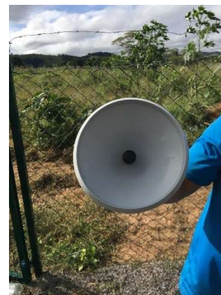
Figura 2.14 - Pluviômetro após a limpeza.
