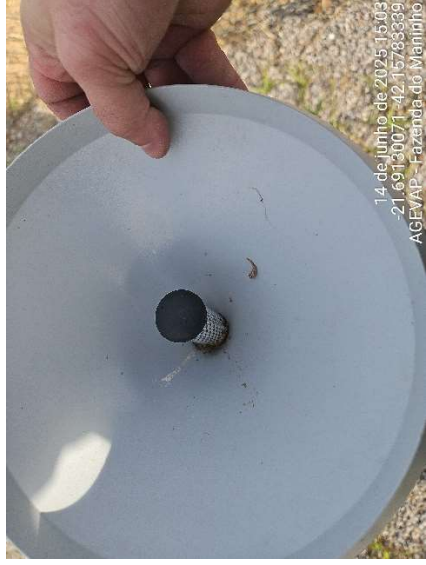
Figura 2.7 - Pluviômetro antes da limpeza.
