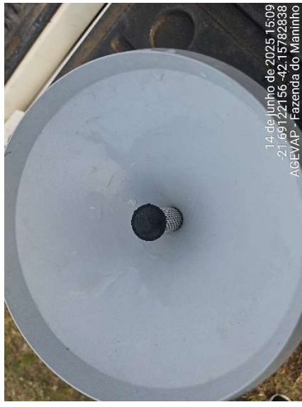
Figura 2.8 - Pluviômetro após a limpeza.
