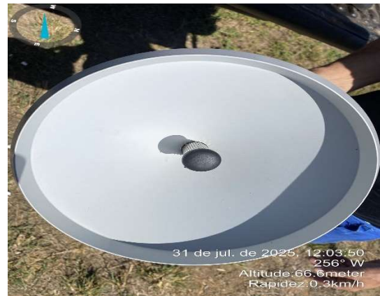
Figura 2.8 - Pluviômetro após a limpeza.
