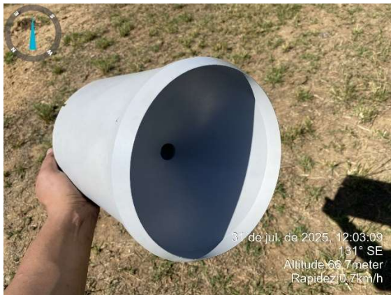
Figura 2.7 - Pluviômetro antes da limpeza.
