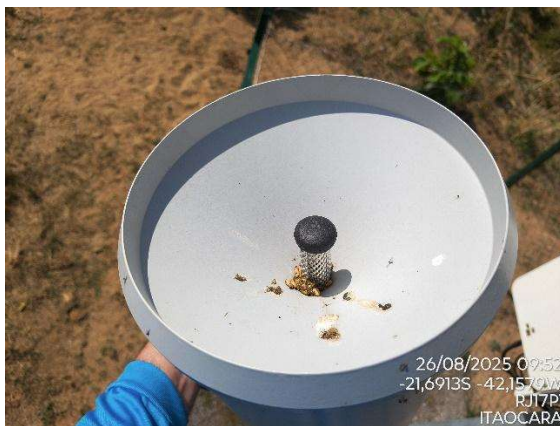
Figura 2.7 - Pluviômetro antes da limpeza.
