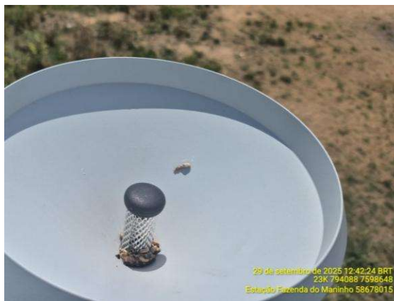
Figura 2.7 - Pluviômetro antes da limpeza.
