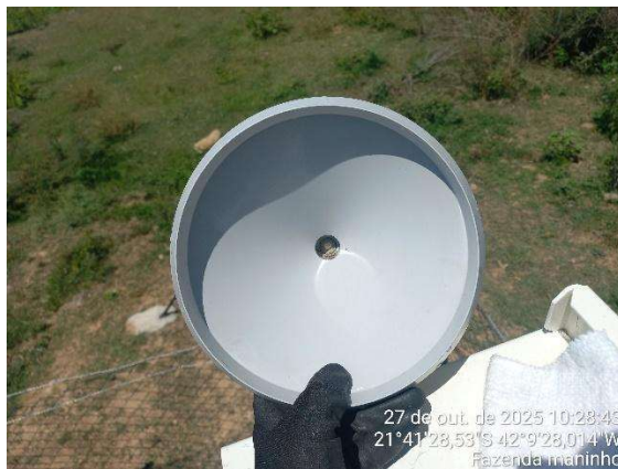
Figura 2.7 - Pluviômetro após a limpeza.
