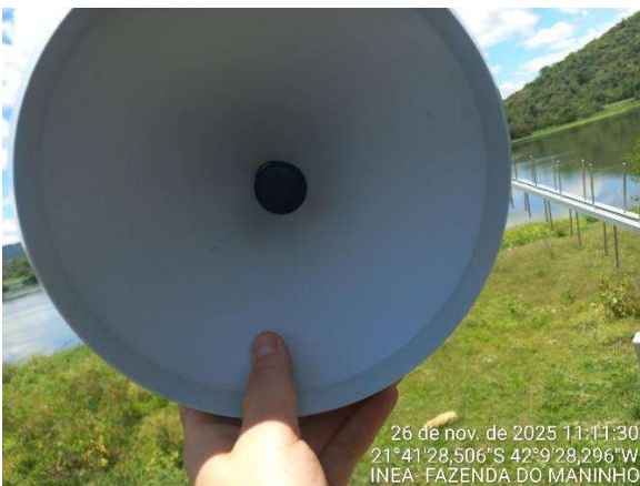
Figura 2.9 - Pluviômetro após a limpeza.
