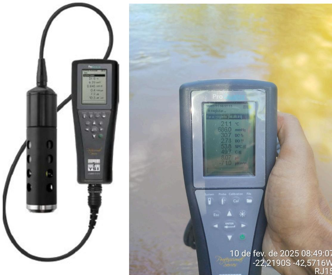
Figura 3.5 Sonda multiparamétrica modelo ProQuatro.
