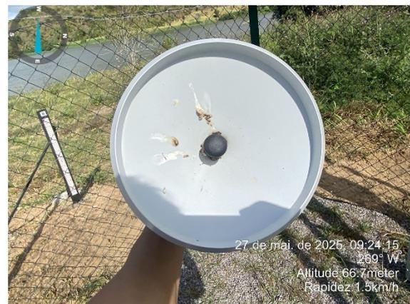
Figura 2.12 - Pluviômetro antes da limpeza
