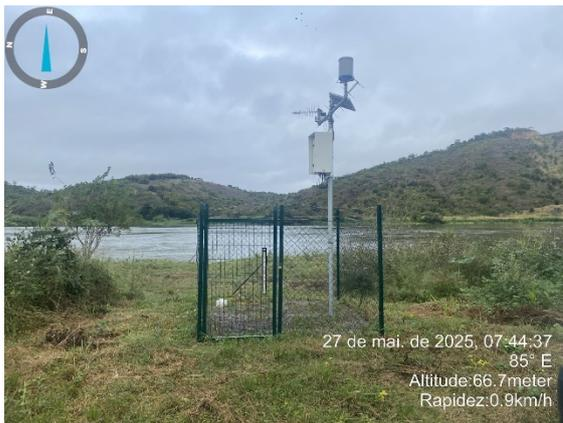
Figura 2.1- Estação telemétrica.
