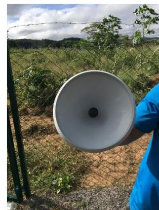
Figura 2.14 - Pluviômetro após a limpeza.
