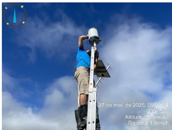
Figura 2.13 - Limpeza o pluviômetro.
