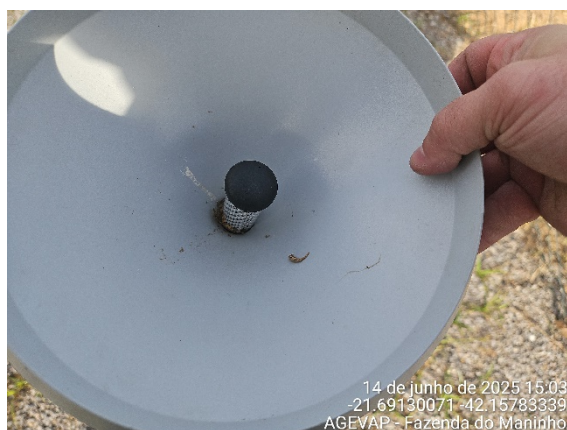
Figura 2.7 - Pluviômetro antes da limpeza.
