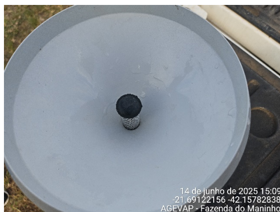
Figura 2.8 - Pluviômetro após a limpeza.
