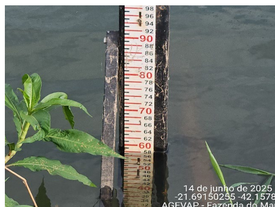
Figura 2.2- Nível marcado na régua.
