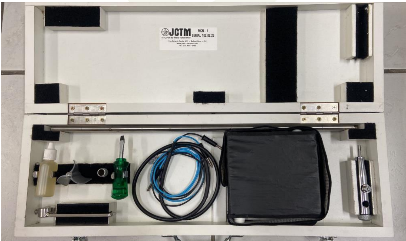
Figura 9 – Micromolinete fluviométrico para medição da vazão de corpos hídricos.
