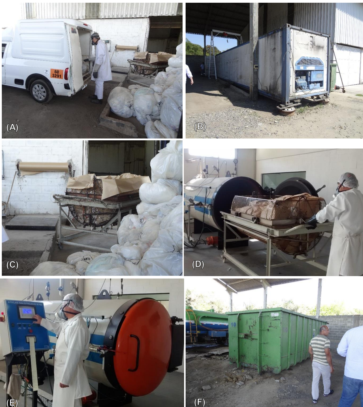
Figura 60 – Processo de autoclavagem dos RSS coletados pela Hidroserv Ltda. na Rest Ambiental Ltda.: (A) Recebimento dos RSS e acondicionamento em contêiner refrigerado; (B) Câmara fria utilizada para acondicionar os RSS até a autoclavagem; (C e D) Transporte e armazenamento dos RSS para o processo de autoclavagem; (E) Funcionário da Rest Ambiental Ltda., realizando o processo de esterilização dos resíduos hospitalares; (F) Contêiner para armazenamento dos resíduos esterilizados, convertidos portanto em resíduos Classe II.
