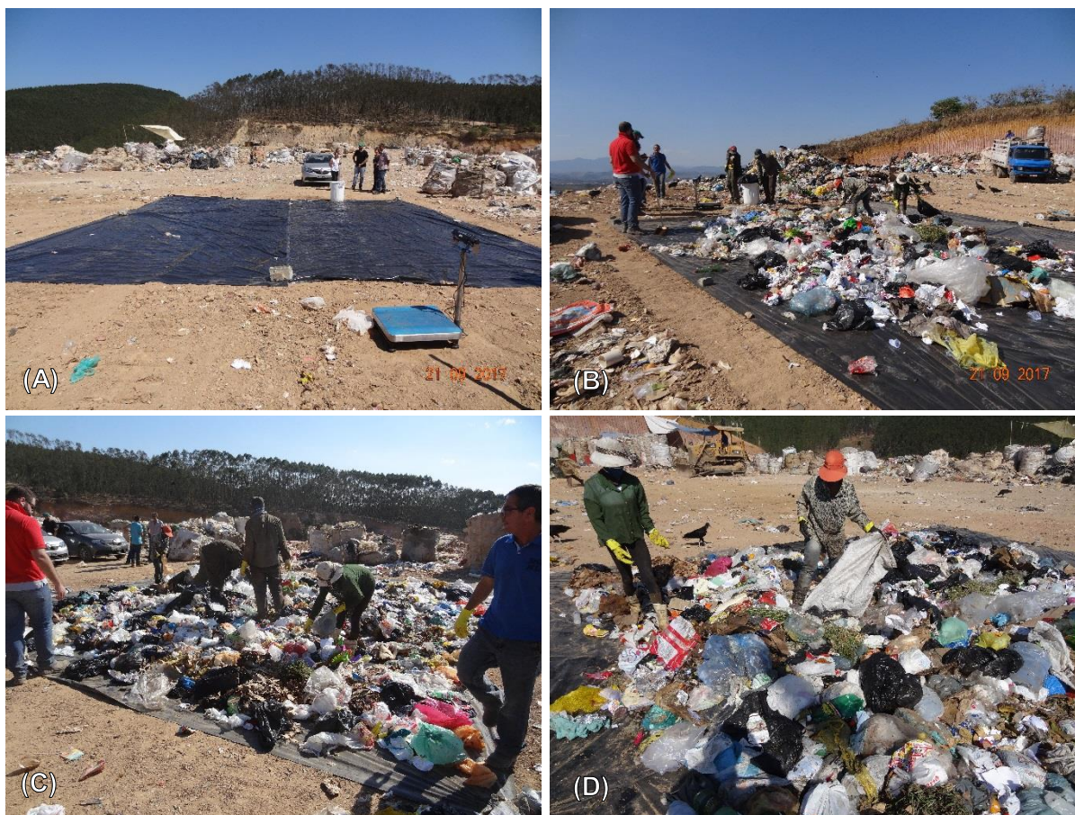
Figura 101 – Processo de rompimento de sacos e homogeneização dos RSD e RSC: (A) Lona preparada para o estudo de gravimetria; (B) Amostras de resíduos dispostas sobre a lona após a determinação da massa específica; (C e D) Rompimento dos sacos plásticos para a triagem e pesagem das diferentes tipologias de resíduos gerados.
