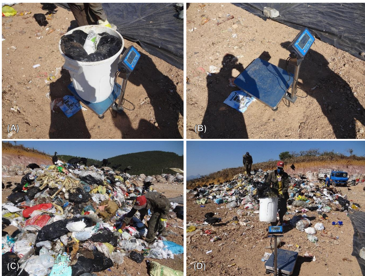
Figura 98 – Realização do ensaio de determinação da massa específica aparente dos resíduos domiciliares e de prestadores de serviços em Resende: (A) Balança digital com precisão de 50g; (B) Bombona plástica com volume de 93 Litros; (C) Coleta de amostras no montante de resíduos vazados pelo caminhão coletor; (D) Pesagem das amostras coletadas para posterior disposição na lona.
