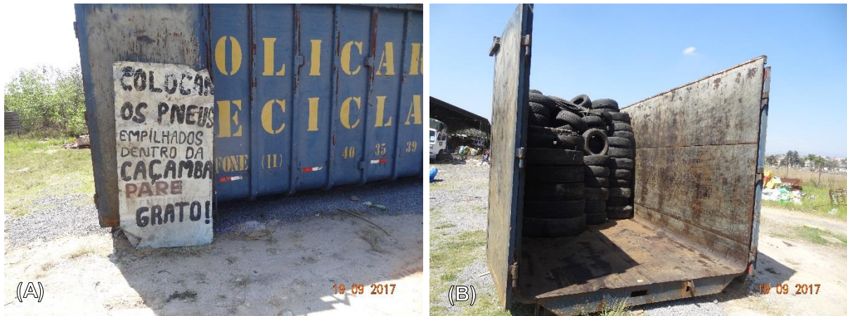
Figura 87 – Caçamba metálica do tipo Roll-on/Roll-off utilizada para o acondicionamento dos pneumáticos inservíveis no pátio da ACRR em Resende: (A) Placa improvisada informando sobre o descarte dos pneus; (B) Inteiro da caçamba onde se nota os pneus empilhados.
