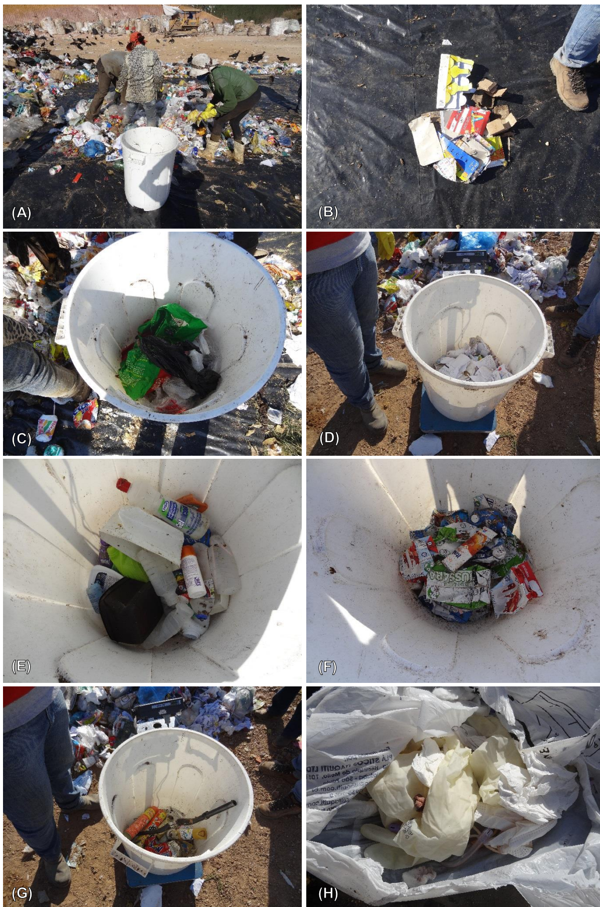
Figura 103 – Segregação dos materiais recicláveis por tipologia para aferição do peso. Fonte: Autores em 21/09/2017.
