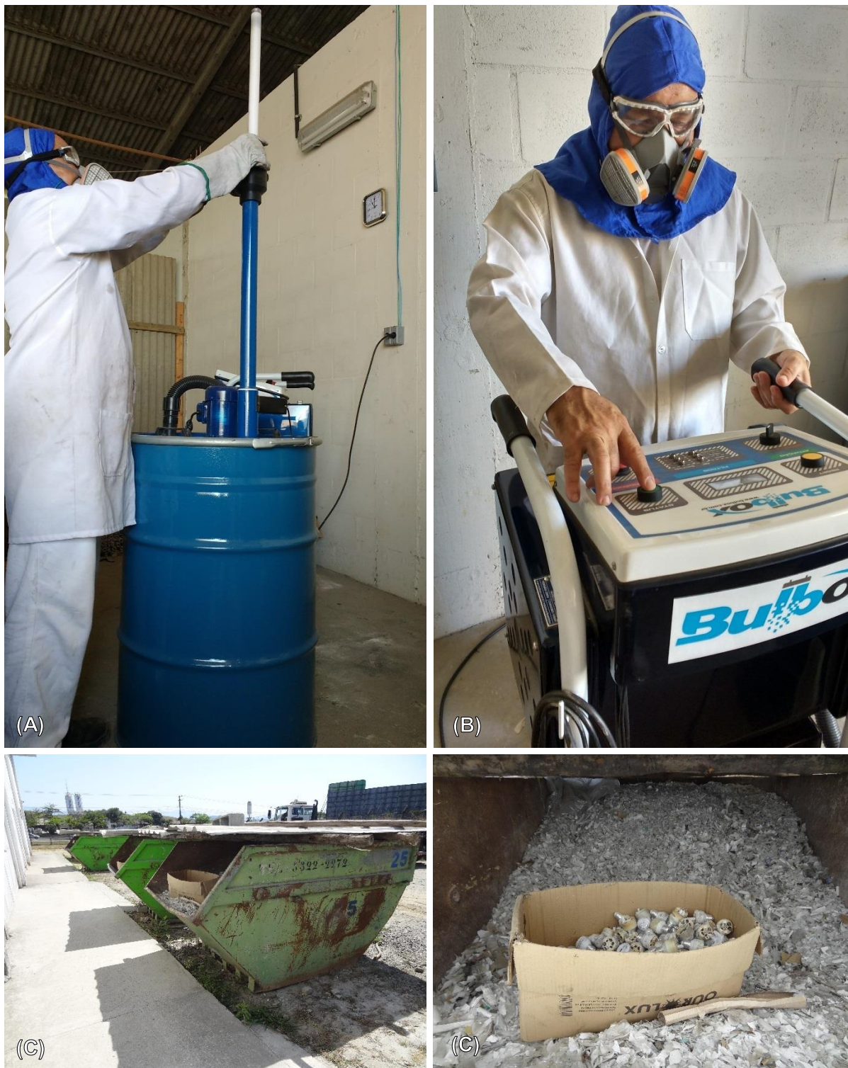
Figura 85 – Processo de descontaminação e armazenamento das lâmpadas: (A e B) Equipamento utilizado para a descontaminação das lâmpadas; (C) Caçambas metálicas com cobertura utilizadas para armazenar os vidros e bulbos após a descontaminação; (D) Vista interna de uma das caçambas metálicas cobertas com os materiais já descontaminados.
