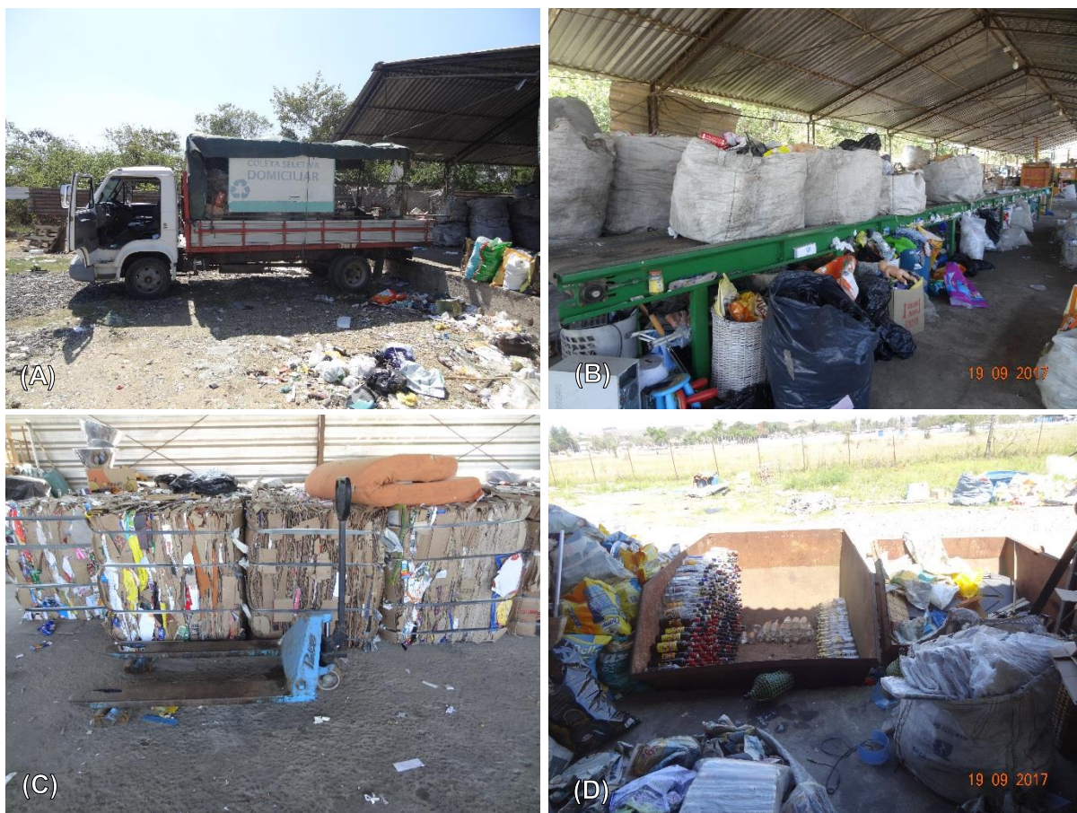
Figura 17 – (A) Materiais recicláveis recolhidos na coleta seletiva realizada pela ACRR sendo descarregado no galpão; (B) Vista da esteira utilizada como mesa separadora onde é realizada a triagem manual dos materiais; (C) Fardos de papelão para comercialização; (D) Caçamba metálica utilizada para o acondicionamento de garrafas de vidro.
