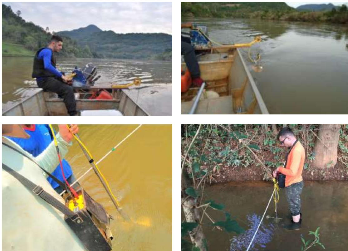
Figura 6.2 Medição de descarga líquida com molinete hidrométrico embarcado e a vau (ÁGUA E SOLO, 2019).
