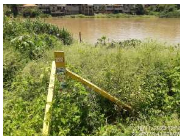
Figura 4.147. RJ06 - Réguas limnimétricas.
