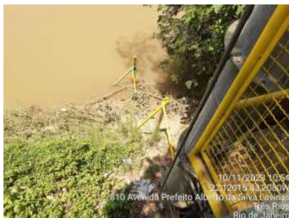
Figura 4.170. RJ09 - Régua limnimétrica.
