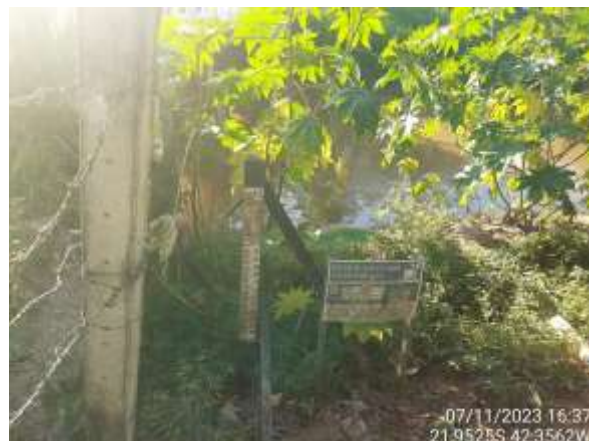
Figura 4.215. RJ16 - Régua limnimétrica.
