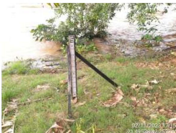
Figura 4.264. RJ29 - Régua limnimétrica.
