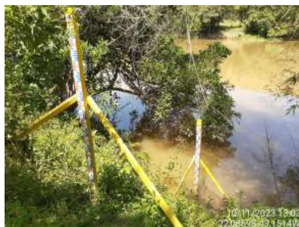
Figura 4.199. RJ13 - Réguas limnimétricas.
