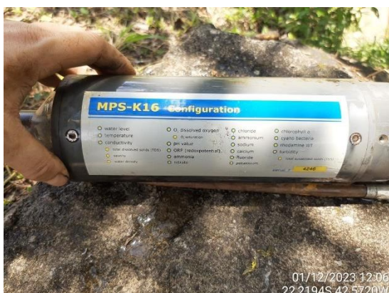
Figura 2.15. RJ15 – Sonda multiparamétrica.
