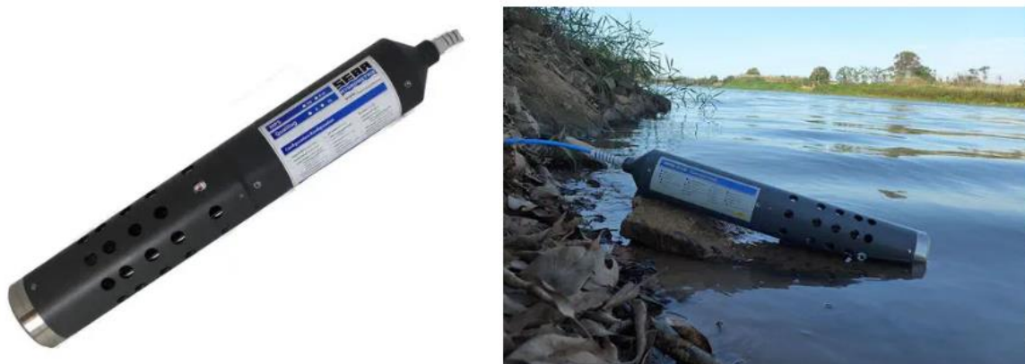
Figura 3. Sonda multiparamétrica modelo MPS K16.
