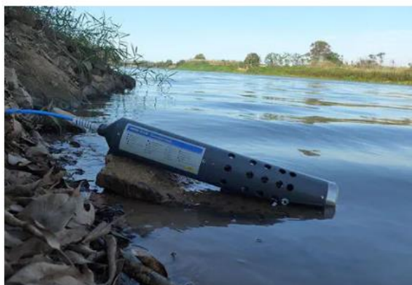
Figura 2.1. Sonda multiparamétrica modelo MPS K16.
