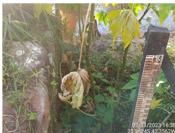
Figura 2.36. RJ16 – Seção de réguas com sinais de abandono.
