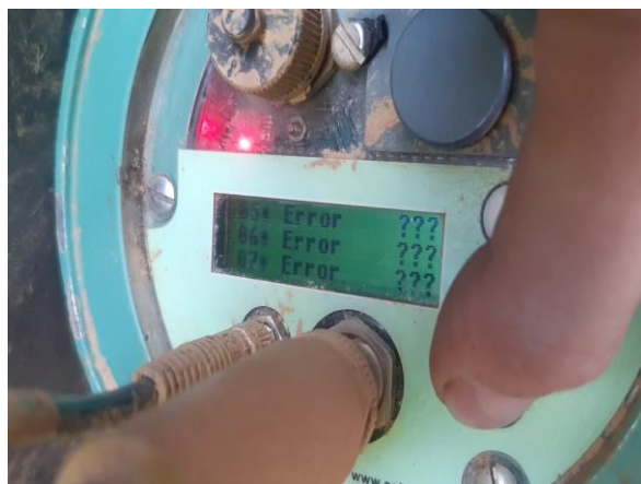
Figura 2.51. RJ25 – Registro da PCD sem dados obtidos através dos sensores.
