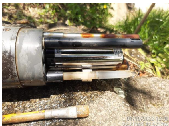
Figura 2.14. RJ15 - Sensores após da limpeza.
