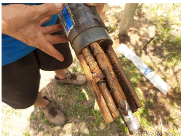
Figura 2.13. RJ15 - Sensores antes da limpeza.
