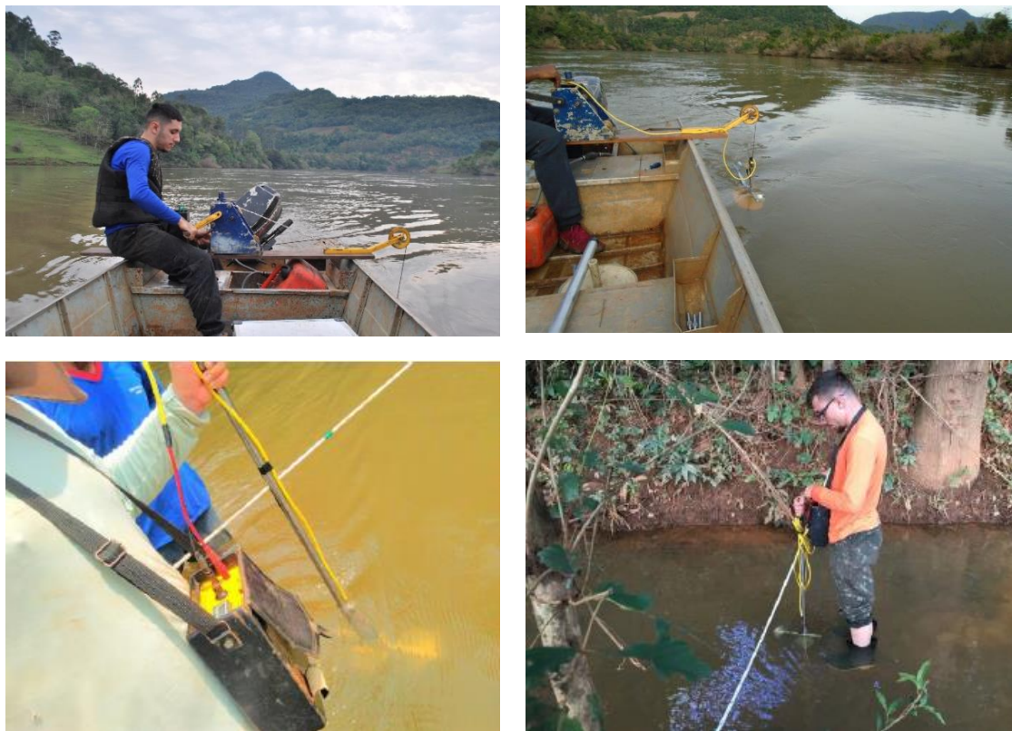
Figura 3.1 Medição de descarga líquida com molinete hidrométrico embarcado e a vau (ÁGUA E SOLO, 2019).
