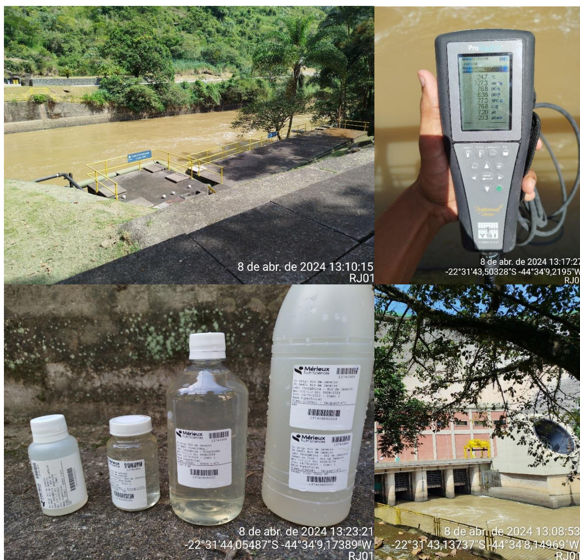
Figura 4.3. Registros fotográficos do ponto RJ01 - Usina do Funil, destacando a seção de medição, a medição de vazão e de parâmetros de qualidade da água, e a coleta de amostras de água.
