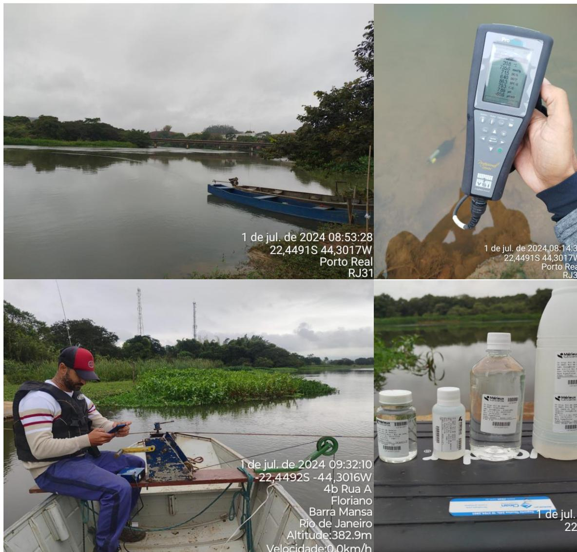
Figura 4.62. Registros fotográficos do ponto RJ31 - Porto Real, destacando a seção de medição, a medição de vazão e de parâmetros de qualidade da água, e a coleta de amostras de água.
