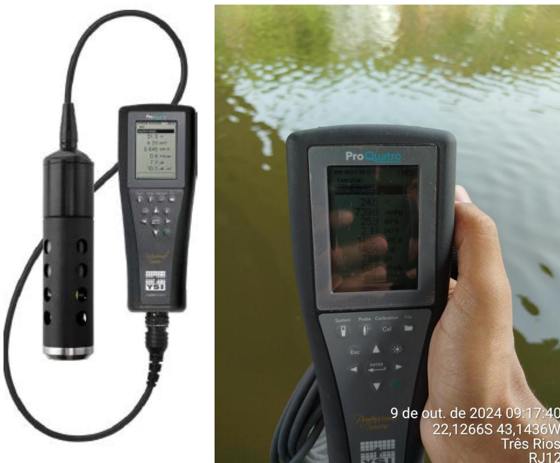
Figura 3.3 Sonda multiparamétrica modelo ProQuatro.
